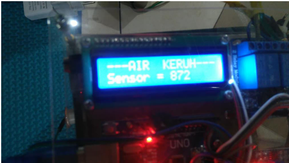
Gambar Hasil Pengujian Sensor Kekeruhan (LDR) Air Keruh
