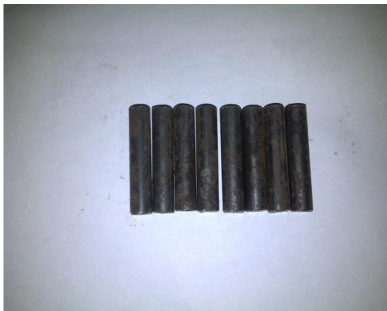
Gambar 3.3 : Benda uji Baja st 60 sebelum dibubut
