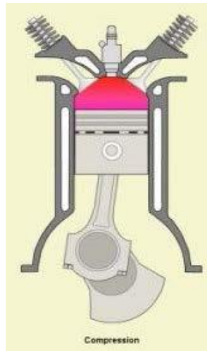
Gambar 2.6: Proses langkah kompresi
