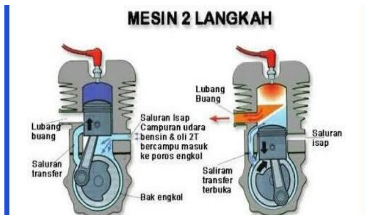
Gambar 2.3: Prinsip kerja motor 2 langkah
