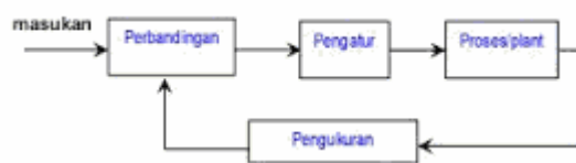
Gambar 2.9 Sistem Kontroller Tertutup
