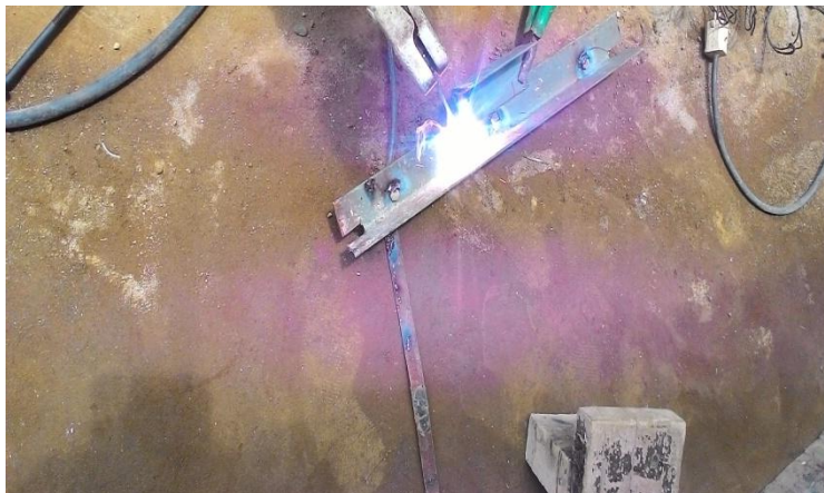
Gambar 3.8 Memasang Dudukan Plat Penekuk
