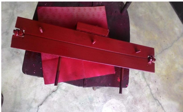
Gambar 3.10 Alat Penekuk Plat Yang Dibuat
