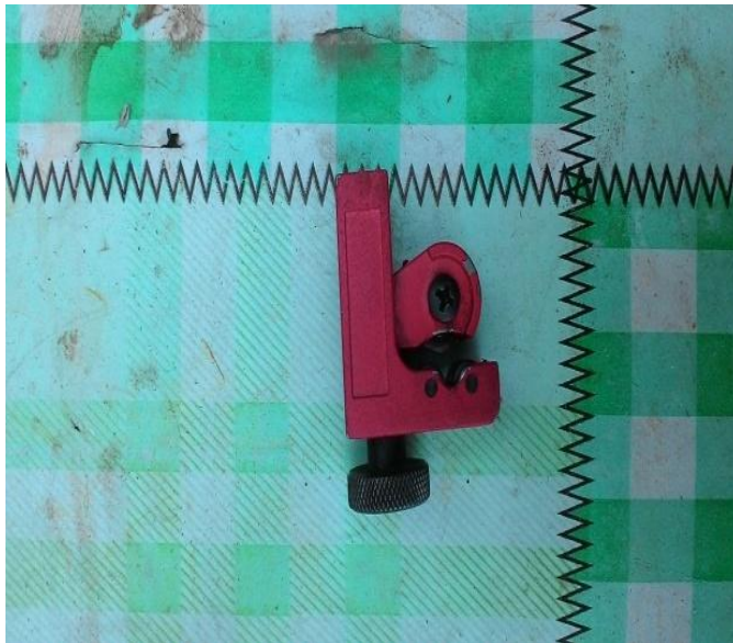
Gambar 3.11 Alat Pemotong Pipa Pada Mesin Kubus Es Berukuran Kecil
