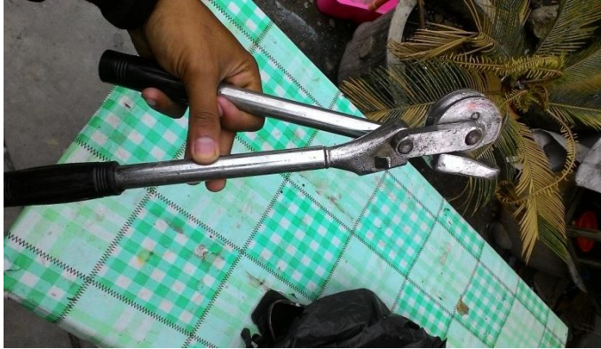
Gambar 3.12 Alat Pembengkok Pipa Pada Mesin Kubus Es
