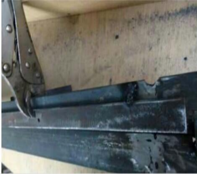
Gambar 3.7 Membuat Dudukan Tempat Penekukan Plat
