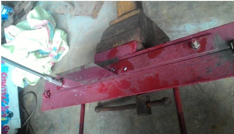
Gambar 4.1 Penekuk plat pada mesin kubus es
