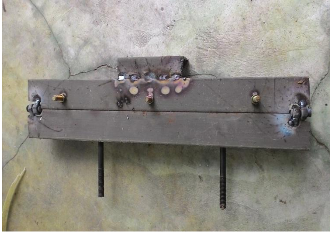
Gambar 3.6 Plat Sudah Disatukan Dengan Baut dan Mur
