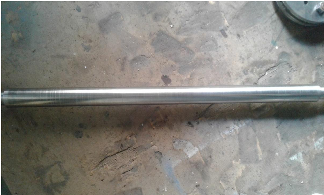
Gambar 4.24. Hasil Jadi Poros Dudukan Benda Uji
