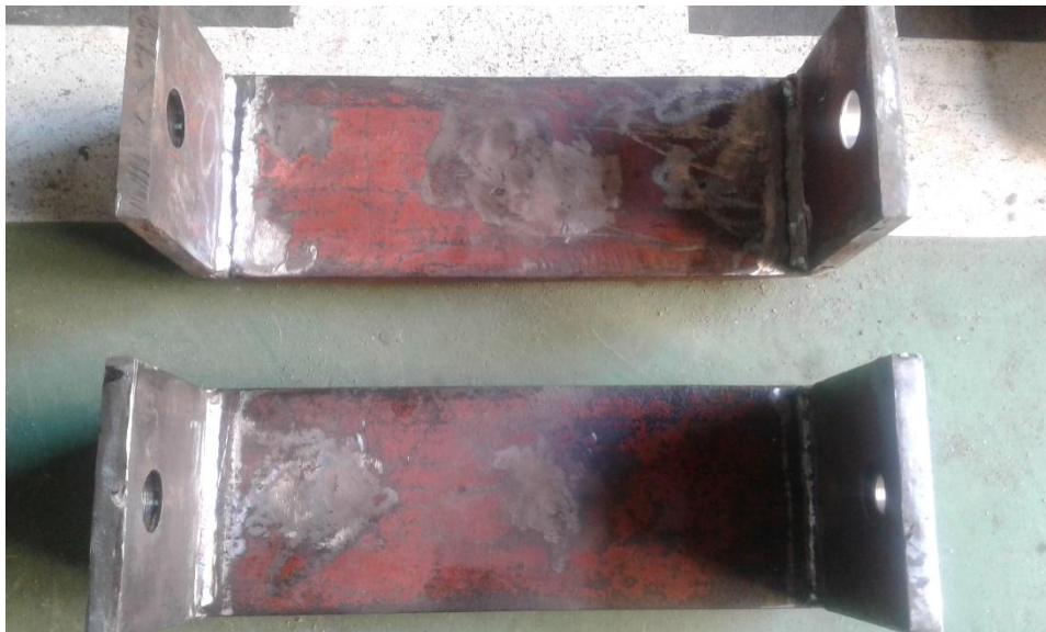
Gambar 4.14. Hasil Jadi Dudukan Vibrasi
