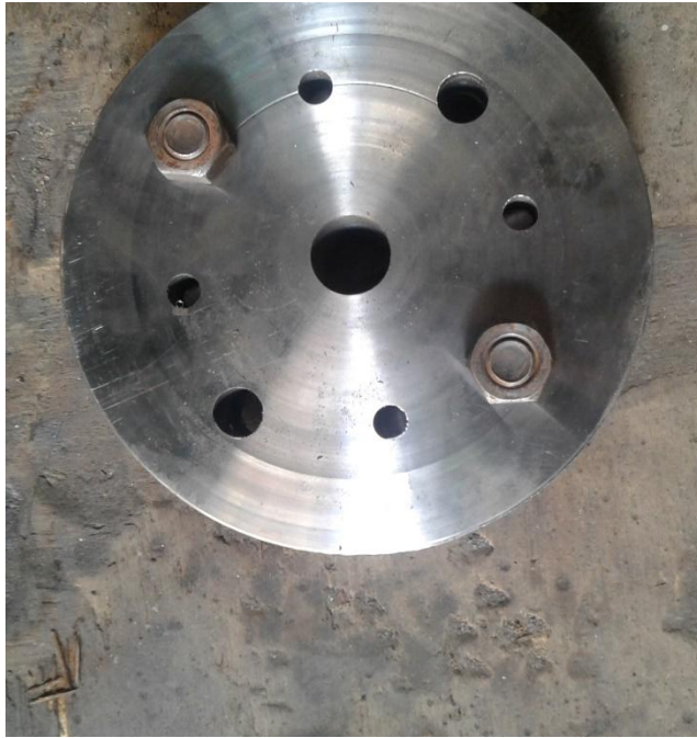
Gambar 4.22. Hasil Jadi Flange Pengikat Benda Kerja
