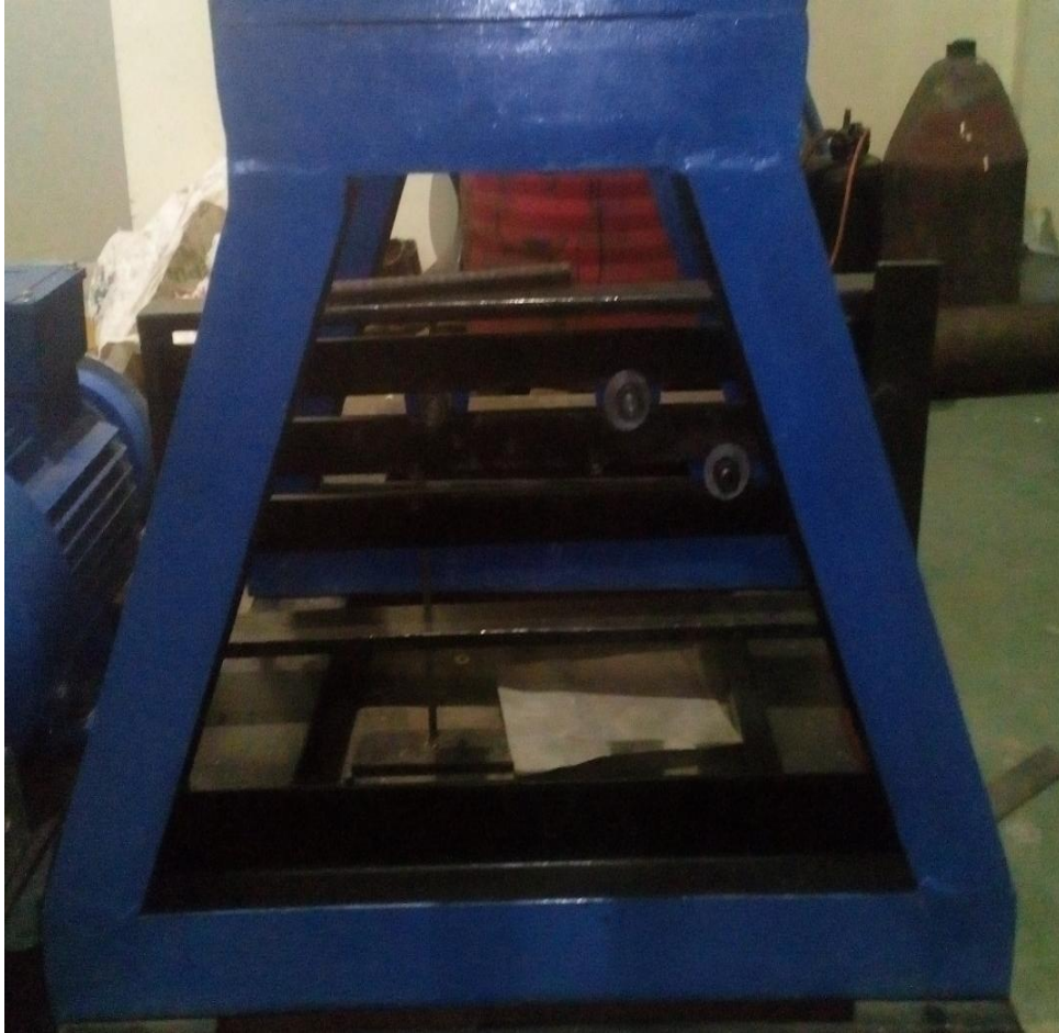
Gambar 4.4 Hasil Jadi Tiang Kaki Untuk Dudukan Rumah Ayunan Vibrasi
