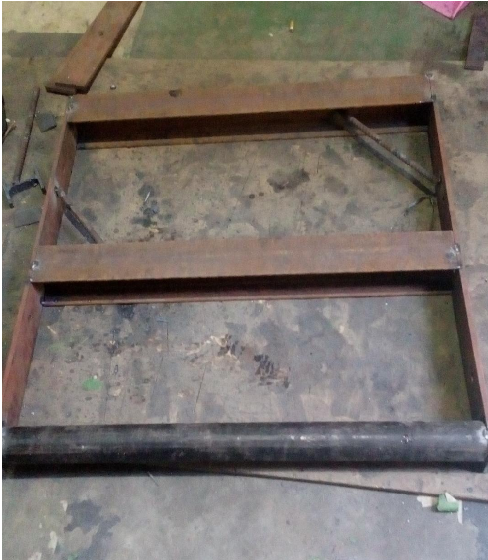
Gambar 4.2 Hasil Jadi Dudukan Alat Uji Dynamic Balancing
