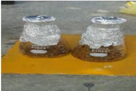
5. Memanaskan erlenmeyer yang berisi TKKS kedalam autoclave hingga temperatur  $121^{\circ}\text{C}$  selama 60 menit.
