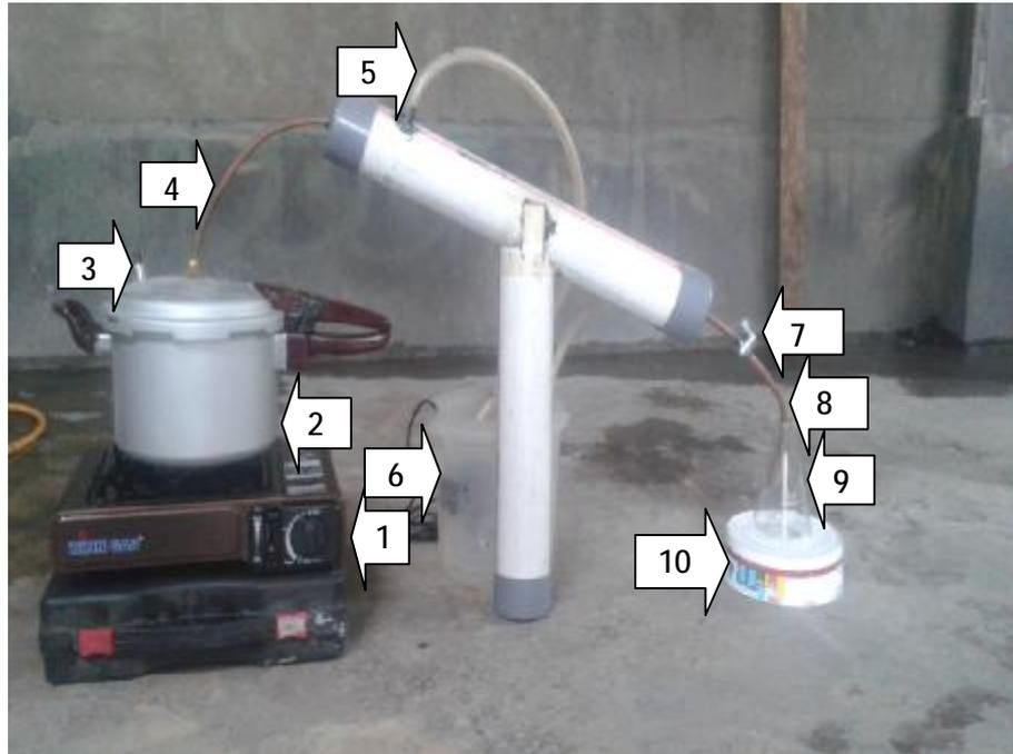
**Gambar 3.27 Skema Alat Destilasi**
