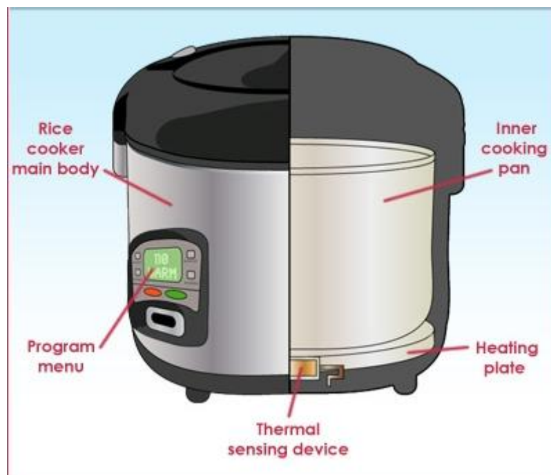
Gambar 2.3. Konstruksi bagian- bagian pokok rice cooker
