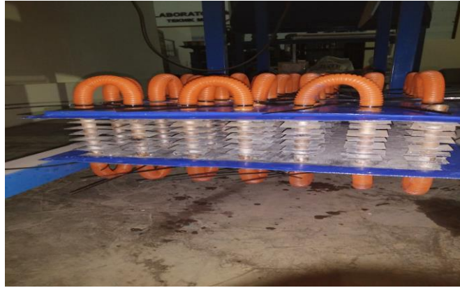
Gambar 3.13 Fine and Tube Heat Exchanger sejajar menggunakan sirip segiempat
