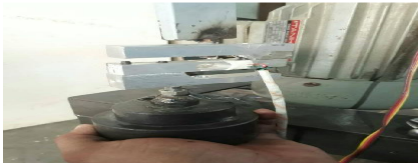
Gambar 3.17 Pemasangan beban seberat 1,18kg
