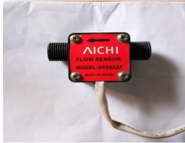
Gambar 3.7 Sensor Flow Meter dan letak sensor pada saat pengujian
