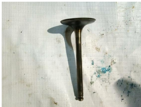
Gambar 3.4 Katup masuk dengan variasi (28 mm)
