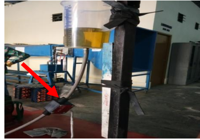
Gambar 3.7 Sensor Flow Meter dan letak sensor pada saat pengujian
