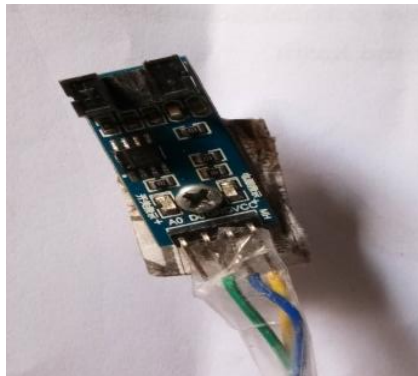
Gambar 3.8 Sensor Kecepatan dan letak sensor pada pengujian
