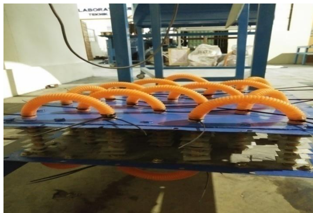
Gambar 3.16 Fine and Tube Heat Exchanger dengan sirip segiempat Tubeselang
