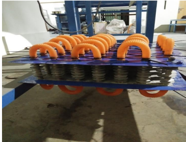
Gambar 3.15 Fine and Tube Heat Exchanger dengan sirip lingkaran Tube Sejajar
