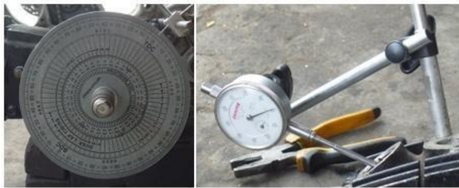
Gambar 3.2 Alat uji busur derajat dan dial test indicator .
