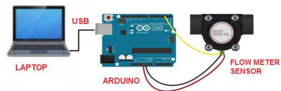
Gambar 3.17 Skema rangkaian Flow meter sensor
