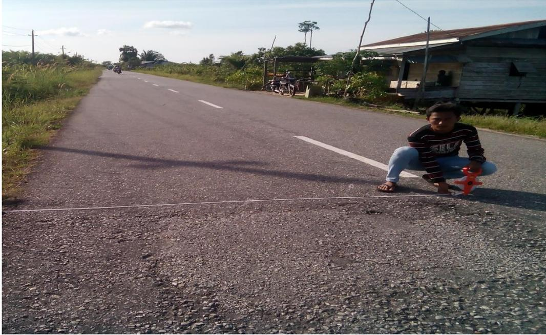
Gambar L.3: Mengukur lebar lajur di jalan Rimo–Singkil.
