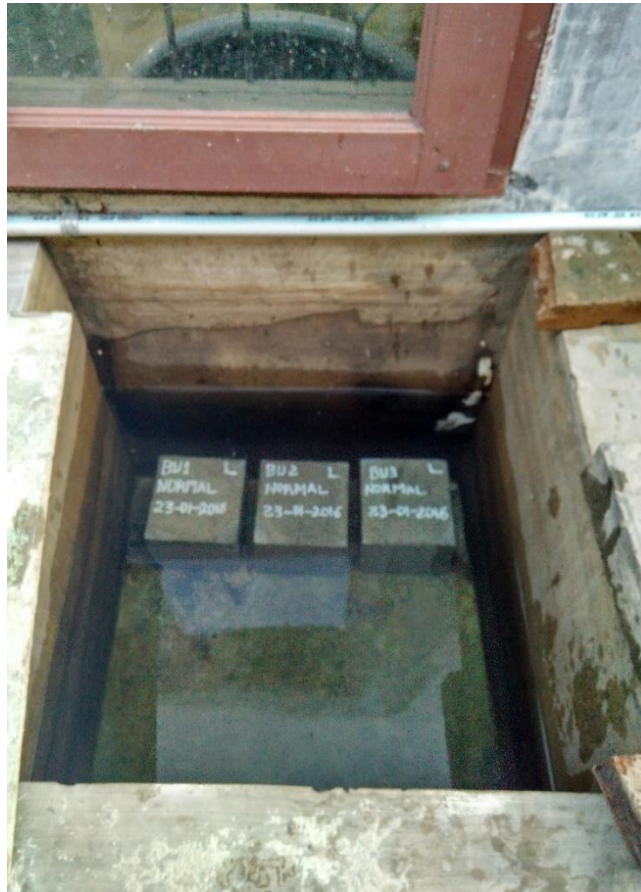
Gambar L9: Proses perendaman benda uji.
