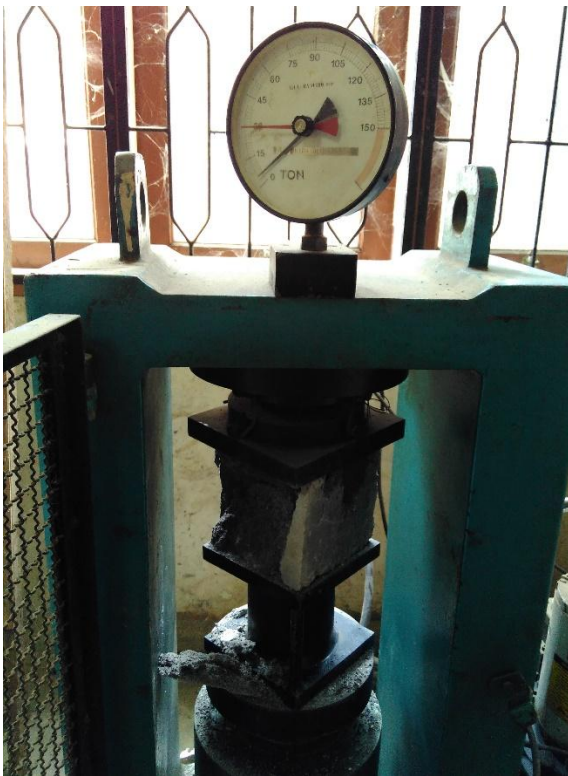
Gambar L12: Uji kuat tekan beton normal 28 hari: 30 T.
