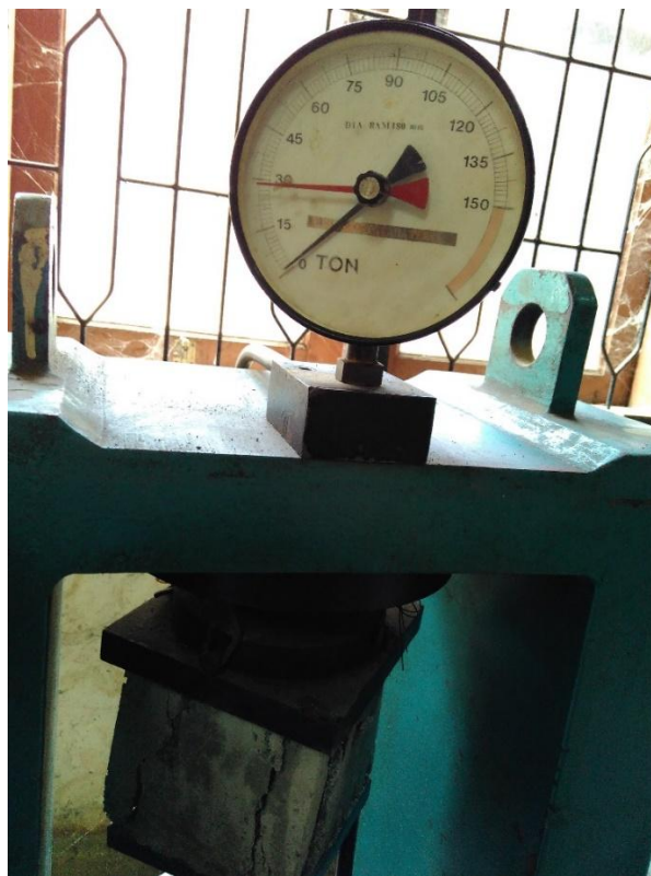
Gambar L13: Uji kuat tekan beton campuran abu tongkol jagung 4% 28 hari: 33 T.
