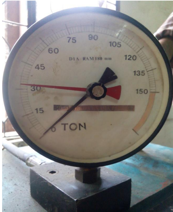
Gambar L13: Uji kuat tekan beton campuran abu tongkol jagung 4% 28 hari: 33 T.
