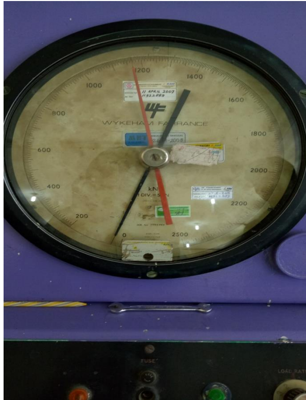
Gambar L13: Uji kuat tekan beton campuran serbuk kaca 16% 28 hari 117 T.
