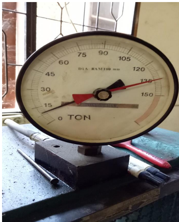
Gambar L14: Uji kuat tekan beton campuran serbuk kaca 18% 28 hari 135 T.
