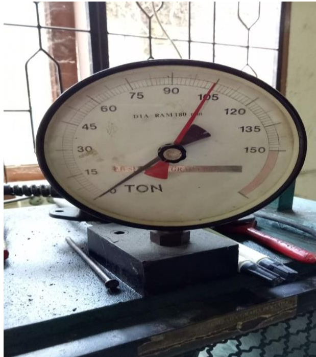
Gambar L11: Uji kuat tekan beton normal 28 hari: 105 T.
