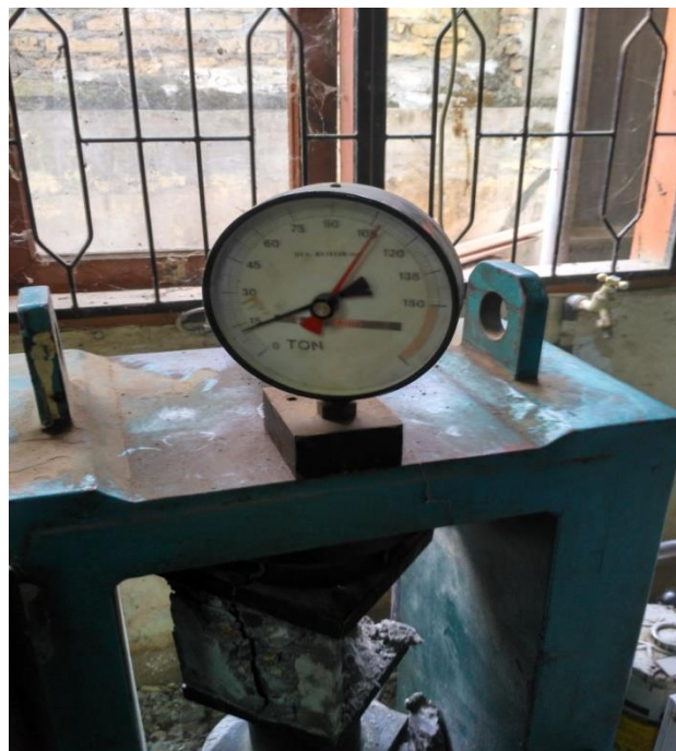
Gambar L12: Uji kuat tekan beton campuran serbuk kaca 14% 28 hari: 108 T.
