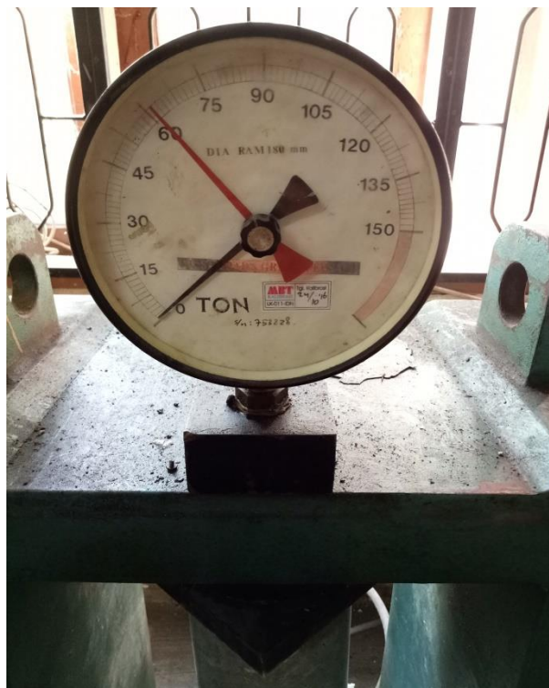
Gambar L18: Uji kuat tekan beton normal Sunggal 28 hari.
