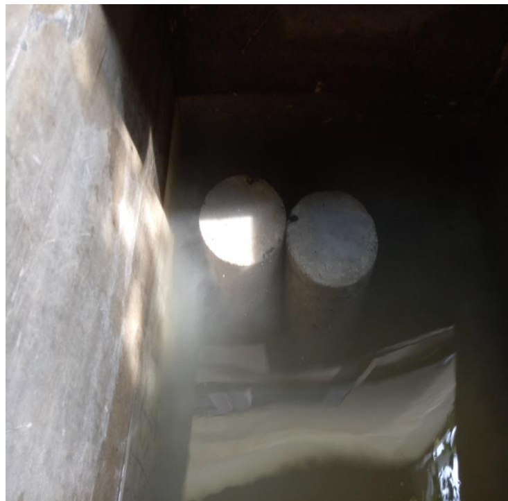
Gambar L12: Proses perendaman beton.
