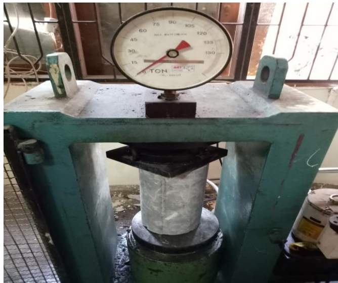
Gambar L14: Beton sebelum di uji.
