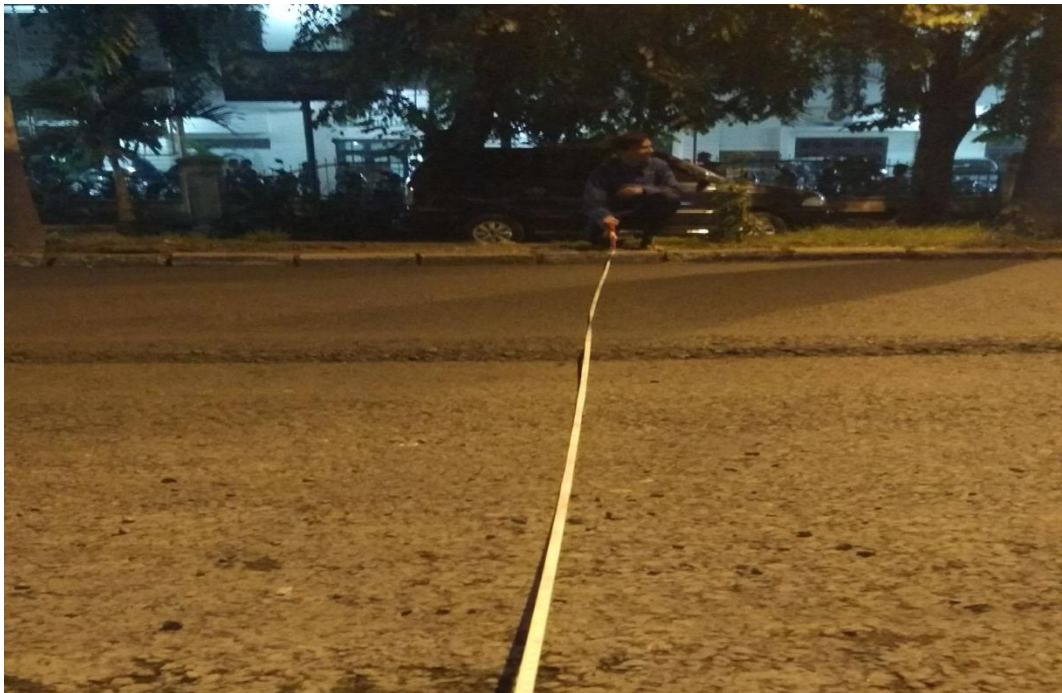
Gambar L.2: Mengukur lebar jalan.
