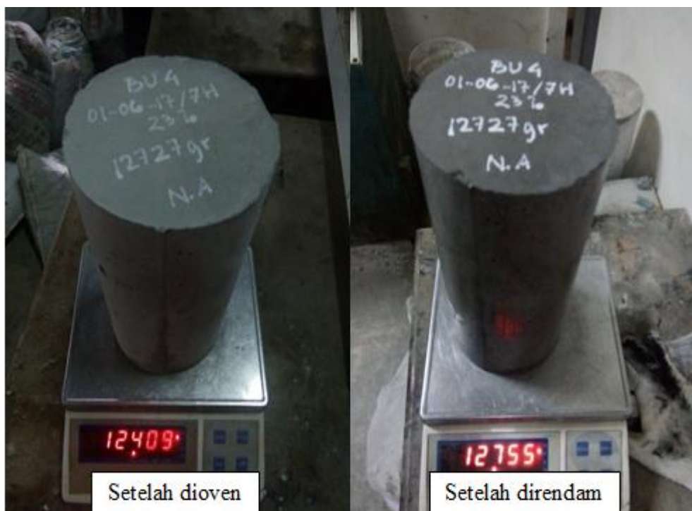
Gambar L.22: Uji serapan air beton campuran serbuk keramik 23% 7 hari.
