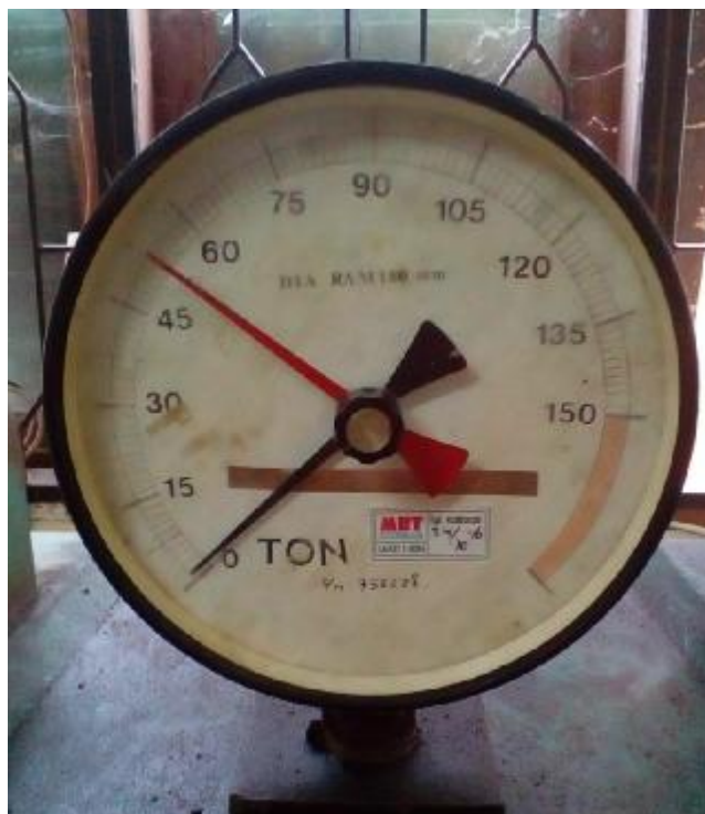
Gambar L.14: Uji kuat tekan beton campuran serbuk kulit rajungan 5% 28 hari FAS 0,4: 51 T.
