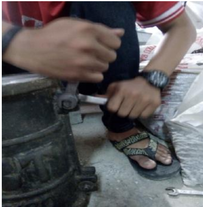
Gambar L.8: Proses pengeluaran benda uji dari cetakan.
