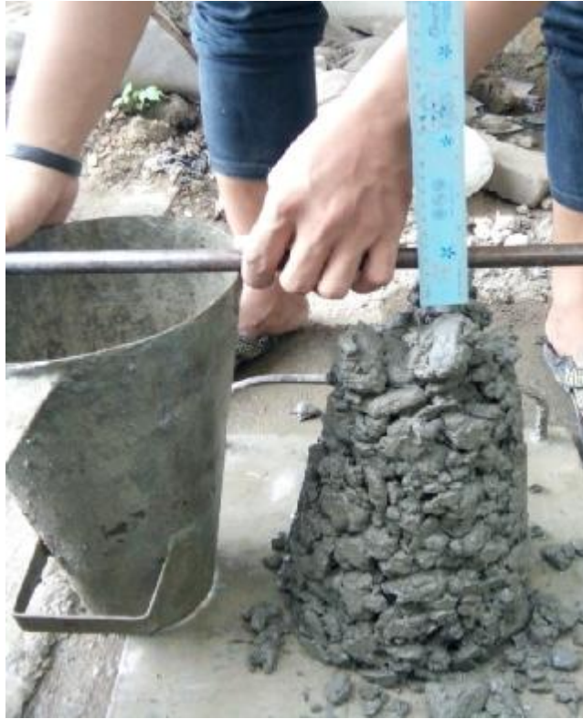
Gambar L.7: Pengujian slump test .
