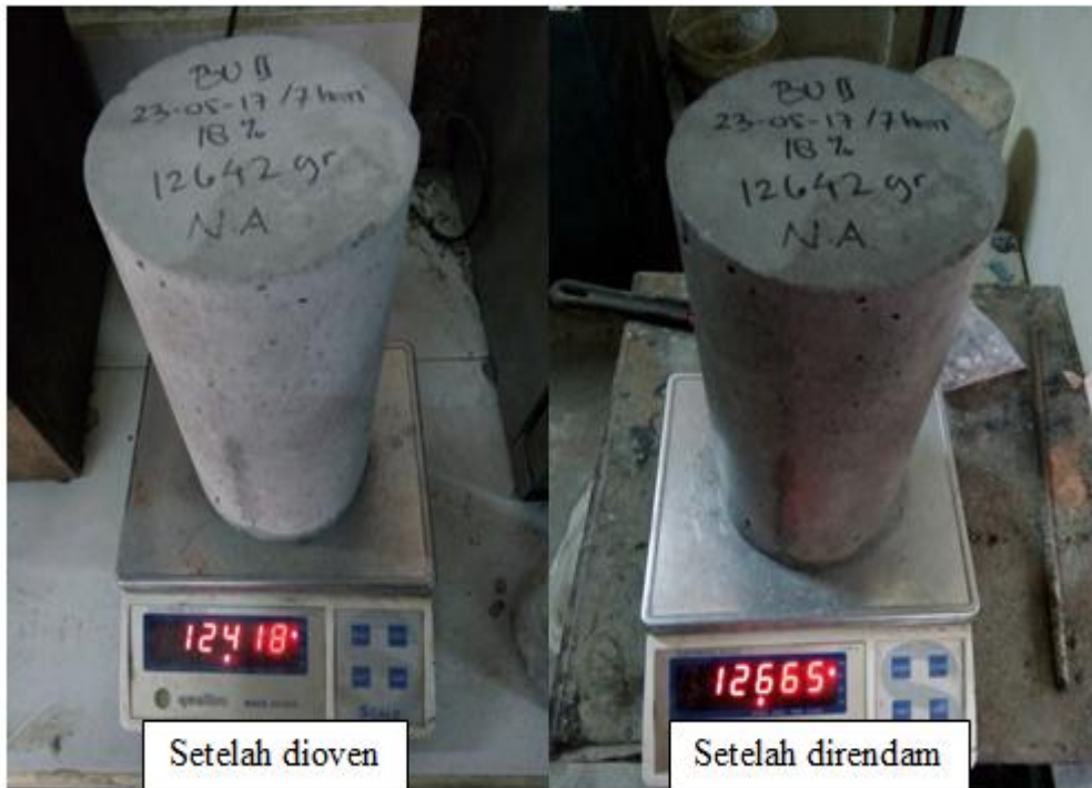
Gambar L.21: Uji serapan air beton campuran serbuk keramik 18% 7 hari.
