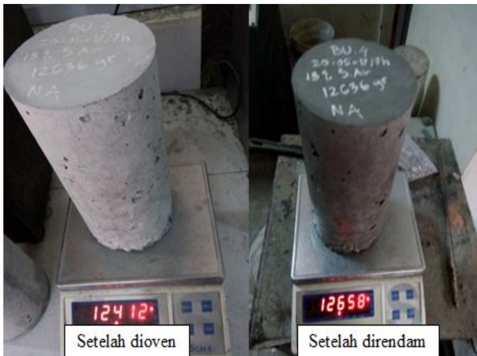
Gambar L.20: Uji serapan air beton campuran serbuk keramik 13% 7 hari.
