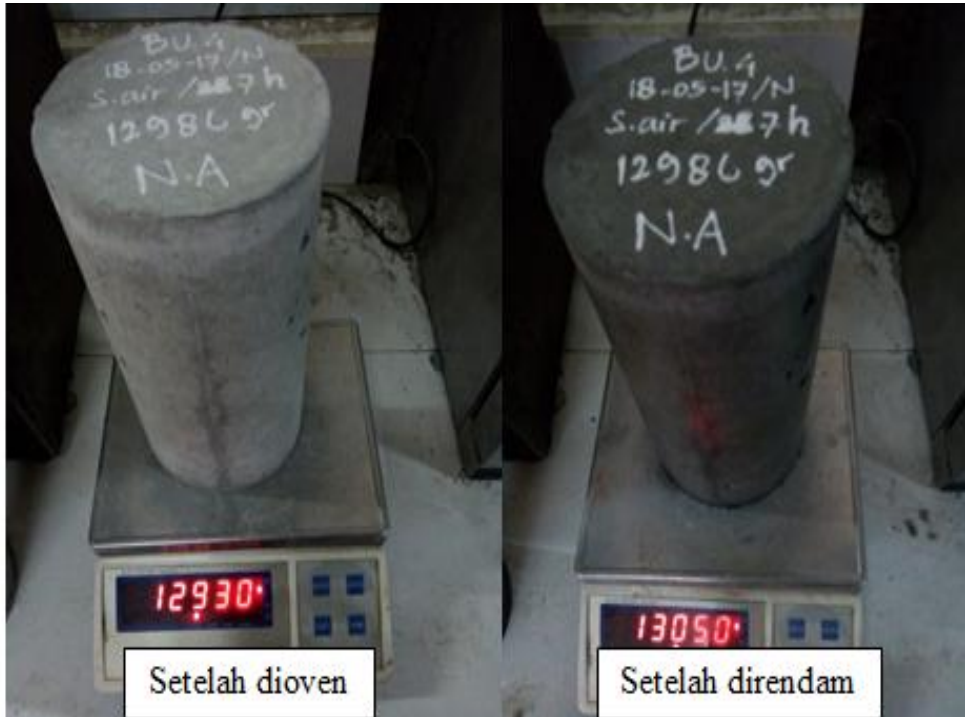
Gambar L.19: Uji serapan air beton normal 7 hari.
