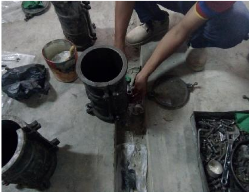
Gambar L.5: Proses perakitan cetakan yang akan digunakan.
