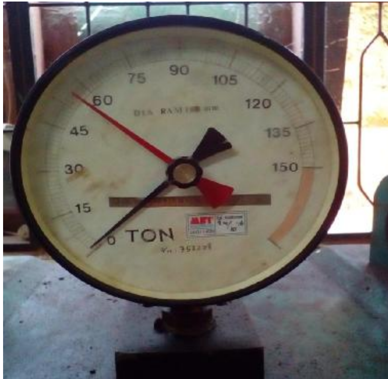
Gambar L.15: Uji kuat tekan beton campuran serbuk kulit rajungan 7% 28 hari FAS 0,4: 57 T.
