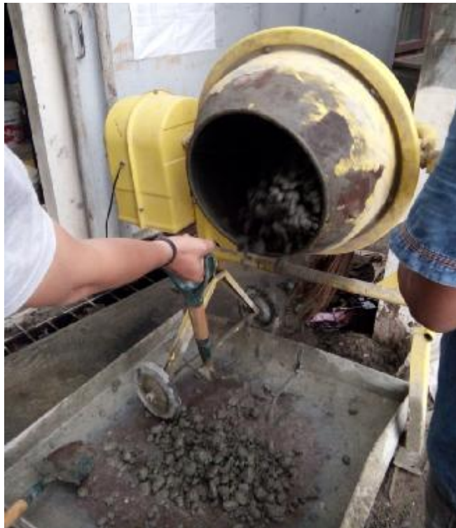
Gambar L.6: Proses pencampuran agregat.
