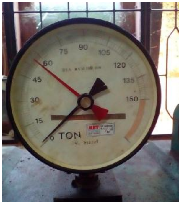
Gambar L.16: Uji kuat tekan beton campuran serbuk kulit rajungan 9% 28 hari FAS 0,4: 57 T.
