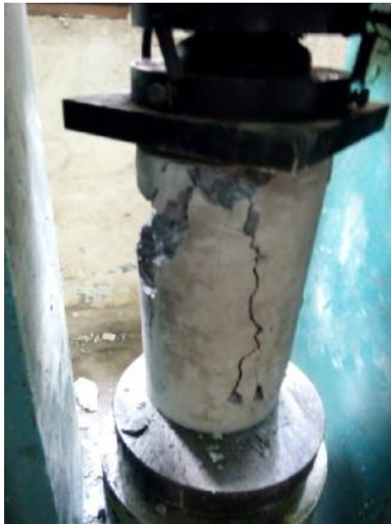
Gambar L.12: Beton setelah diuji tekan.
