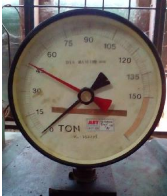
Gambar L.13: Uji kuat tekan beton normal 28 hari FAS 0,4: 47 T.
