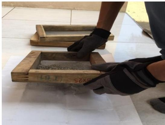
Gambar 4.18 Penyaringan dengan menggunakan saringan T 61.
