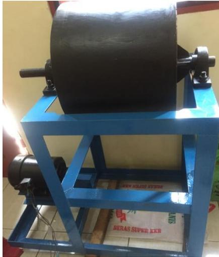
Gambar 3.1 Mesin *Ball Mill*
