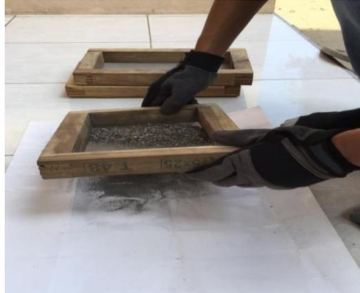
Gambar 4.29 Penyaringan dengan menggunakan saringan T 48.
