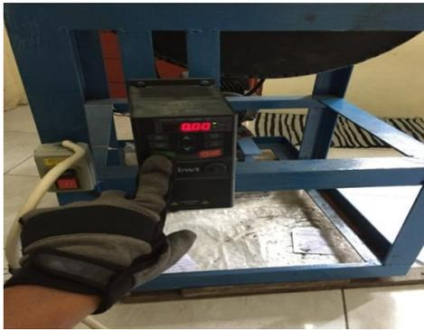
Gambar 4.4 menghidupkan inverter.
