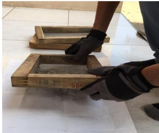
Gambar 4.27 Penyaringan dengan menggunakan saringan T 61.
