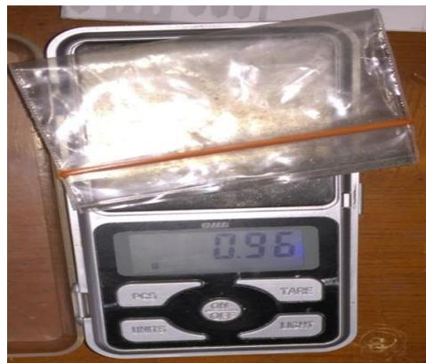
Gambar 4.21 Hasil saringan T 48 menggunakan diameter bola baja 28 mm.
