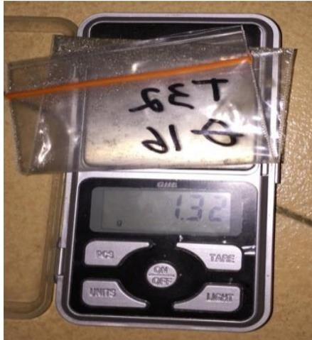
Gambar 4.32 Hasil saringan T 32 menggunakan diameter bola baja 16 mm.
