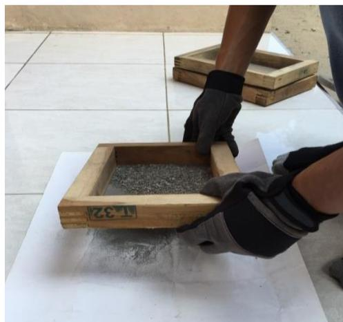
Gambar 4.31 Penyaringan dengan menggunakan saringan T 32.
