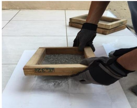
Gambar 4.13 Penyaringan dengan menggunakan saringan T 32.
