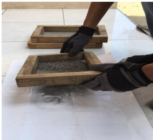
Gambar 4.11 Penyaringan dengan menggunakan saringan T 48.
