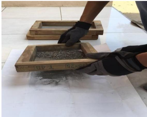
Gambar 4.20 Penyaringan dengan menggunakan saringan T 48.
