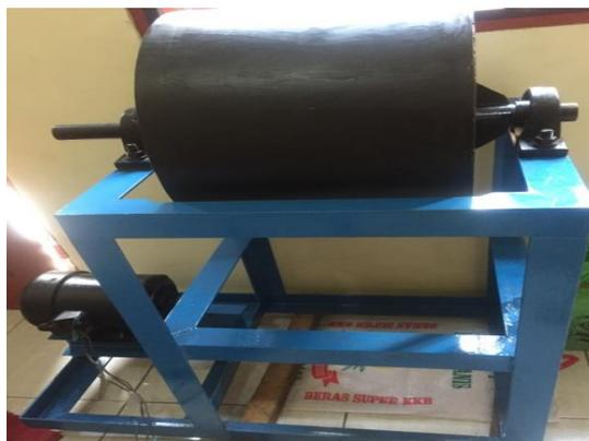
Gambar 2.1 Mesin *Ball Mill*
