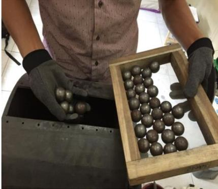
Gambar 4.15 memasukkan bola baja 28 mm.
