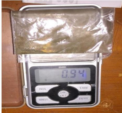
Gambar 4.19 Hasil saringan T 61 menggunakan diameter bola baja 28 mm.
