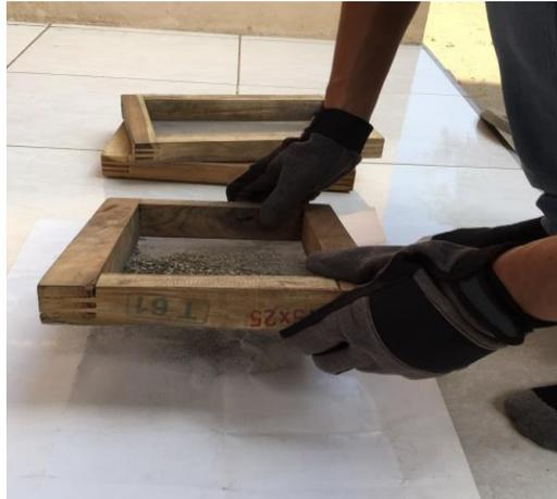
Gambar 4.9 Penyaringan dengan menggunakan saringan T 61.
