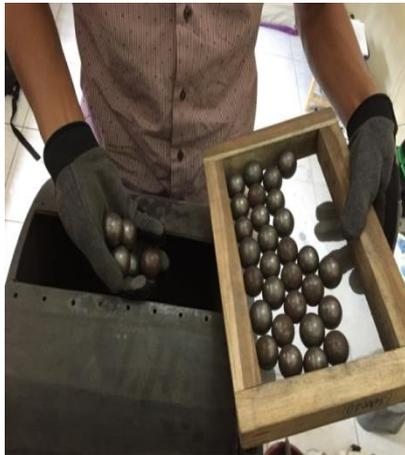
Gambar 4.1 memasukkan bola baja 30 mm.
