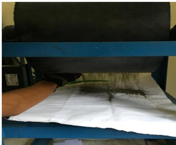
Gambar 4.8 serbuk aluminium di tuangkan ke dalam wadah.
