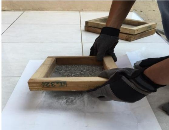
Gambar 4.22 Penyaringan dengan menggunakan saringan T 32.
