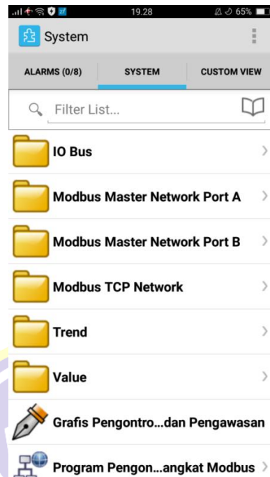
Gambar 4.21 Tampilan beranda tab system pada perangkat lunak SBO Tech Tool setelah login ke Automation Server .
