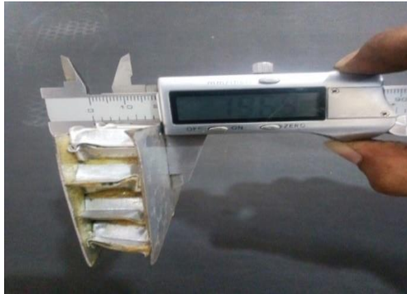
Gambar 4.47 Pengukuran Deformasi Spesimen 6 mm Tekanan 6 Bar
