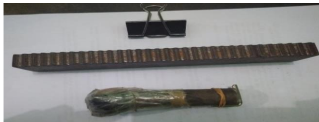
Gambar 3.3: Cetakan pembuat spesimen honeycomb ukuran 2 mm
