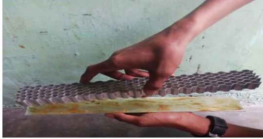
Gambar 4.17 Pemasangan Skin ukuran 4 mm
