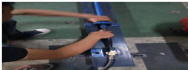
Gambar 4.26 Memasang selang angin
