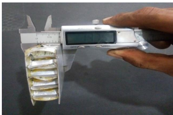
Gambar 4.44 Pengukuran Deformasi Spesimen 4 mm Tekanan 6 Bar
