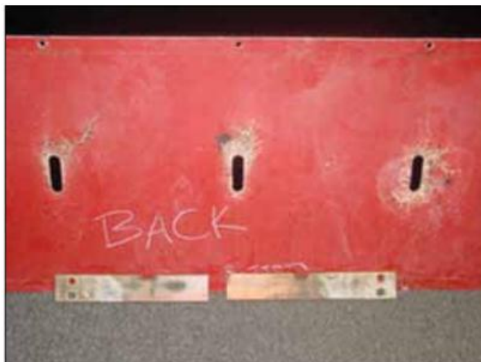
Gambar 2.12 : Dukungan switchgear bus pembatas.
