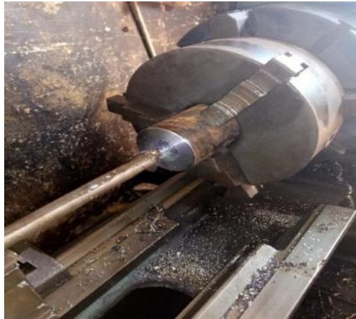
Gambar 3.14 pembuatan dinding container bawah
