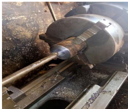
Gambar 3.11 Pembubutan Dinding Container
