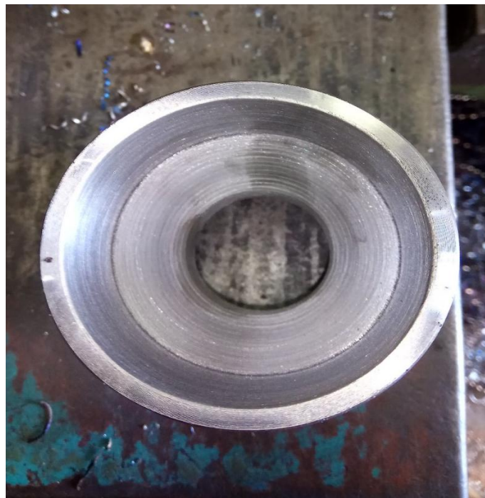
Gambar 4.1 hasil pembuatan die ( cetakan )
