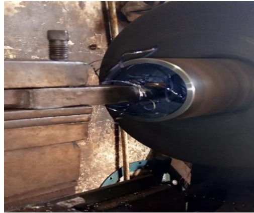
Gambar 3.12 Pembubutan Tirus Die
