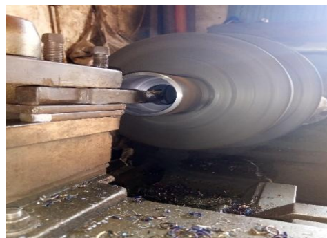
Gambar 3.13 pembubutan lobang die
