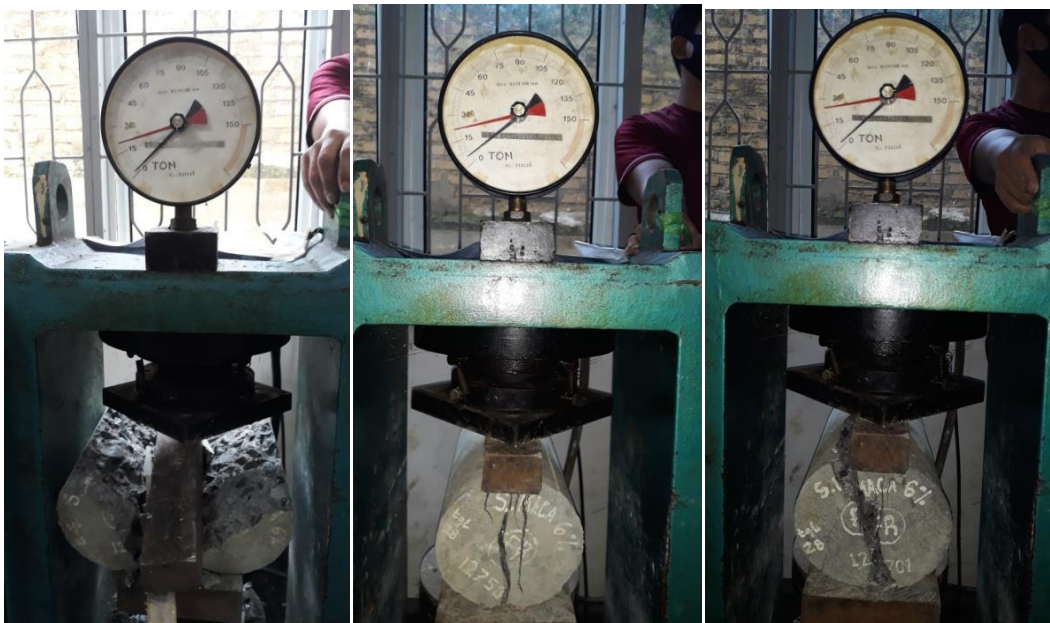
Gambar L-12 Pengujian kuat tarik belah (BK-6)
