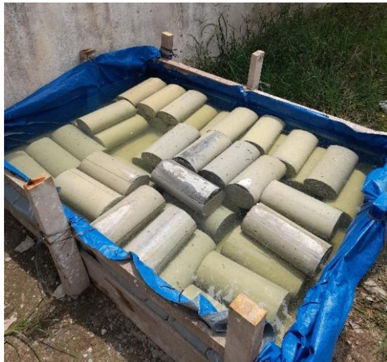
Gambar L-4 Perendaman benda uji
