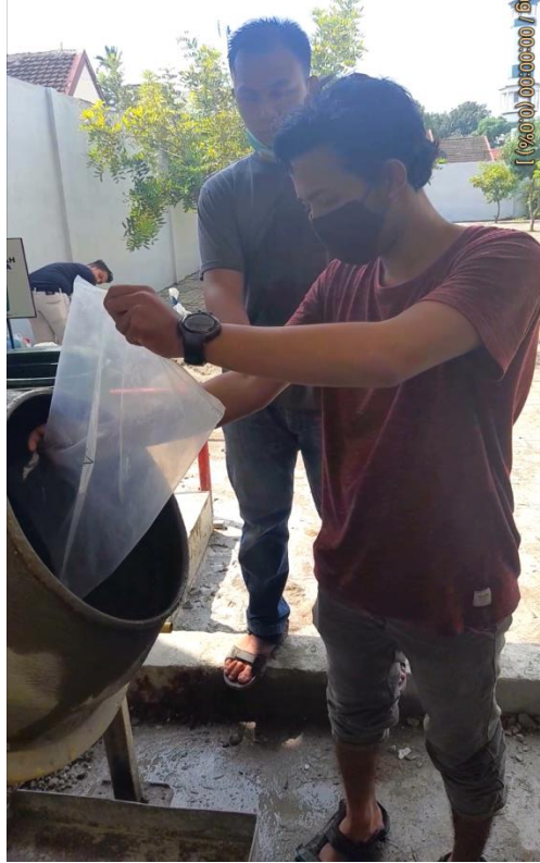
Gambar L-1 Mengaduk semua campuran beton
