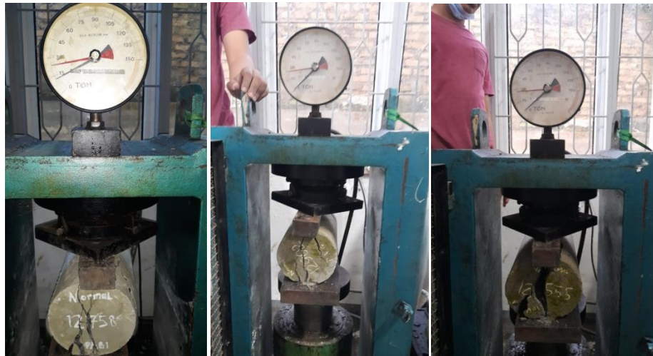
Gambar L-9 Pengujian kuat tarik belah (BN)
