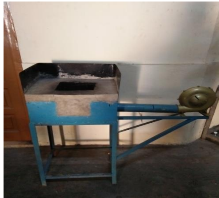
Gambar 4.6 : Tungku Pembakaran Logam
