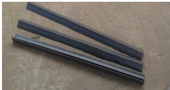
Gambar 3.8 : Besi Profil L St 37
