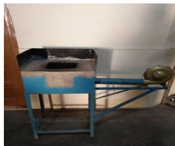
Gambar 4.5 : Hasil Perancangan Tungku Pembakaran Logam
