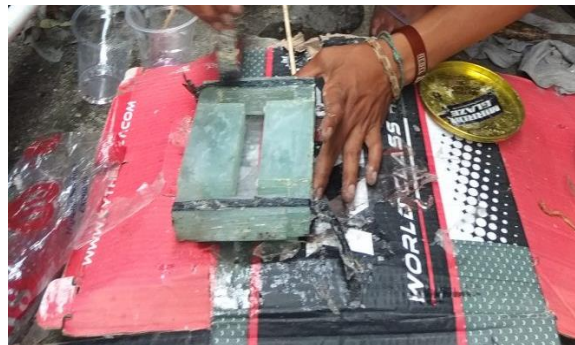
Gambar. 3.17 Mengoleskan mirror glaze pada bagian cetakan spesimen
