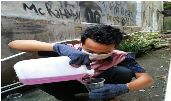
Gambar. 3.18 Menuang resin kedalam wadah.
