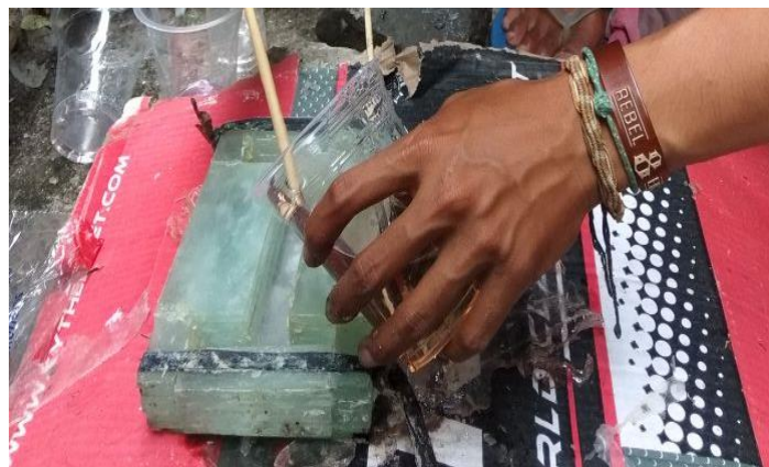
Gambar. 3.21 Penuangan campuran resin dan katalis kedalam cetakan.
