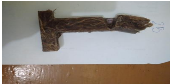
Gambar 5.2 Jenis Patahan spesimen 20 mm.
