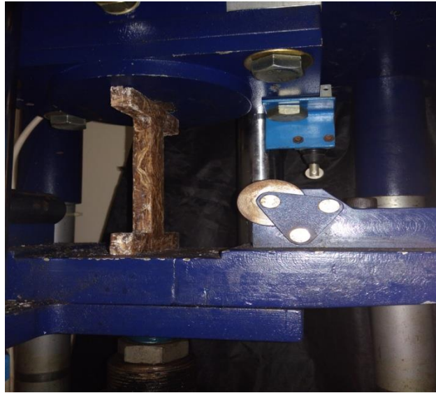
Gambar 3.25. Pemasangan Spesimen padan mesin uji tekan.
