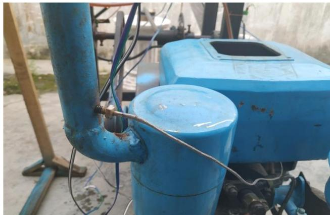
Gambar 3.17. Sensor *Thermocoupe*l
