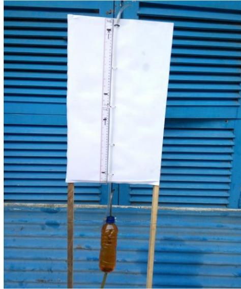
Gambar 3.6 Alat ukur konsumsi bahan bakar solar
