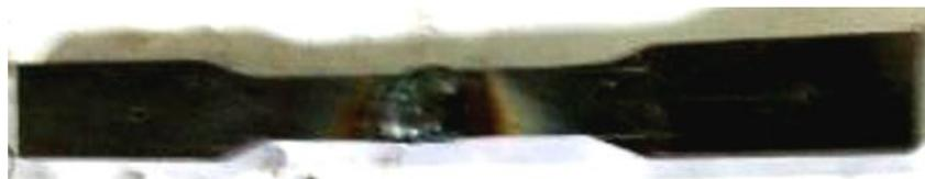
Gambar 3.9 Spesimen setelah di lakukan pengelasan
