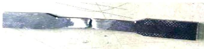
Gambar 3.11 Spesimen hasil uji tarik
