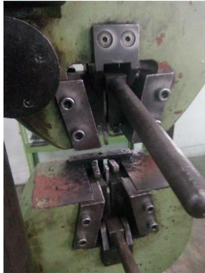
Gambar 3.10 Spesimen diikat padaudukan uji tarik
