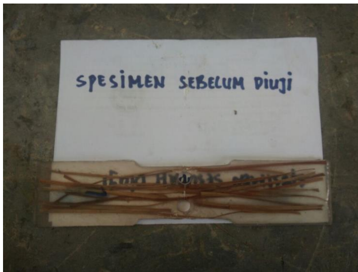
Gambar : 4.1 spesimen komposit sebelum diuji dengan diameter 8 mm.
