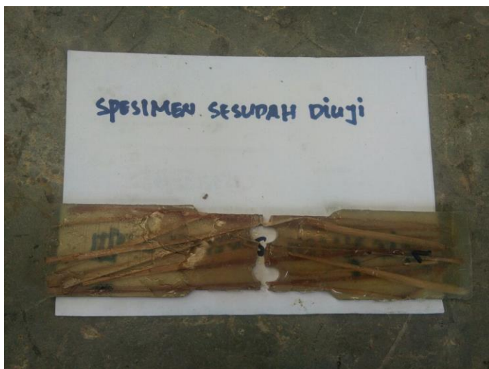
Gambar : 4.2 spesimen komposit sesudah diuji dengan diameter 8 mm.
