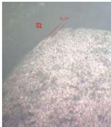
**Gambar 4.1.** Hasil panjang keausan dengan minyak kelapa
