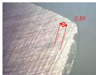
**Gambar 4.3.** Hasil panjang keausan tanpa menggunakan cairan pendingin
