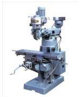
**Gambar 2.2.** Mesin Frais *Vertikal*
