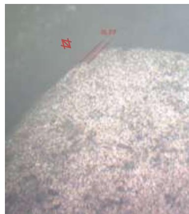
**Gambar 4.1.**Hasil panjang keausan dengan minyak kelapa
