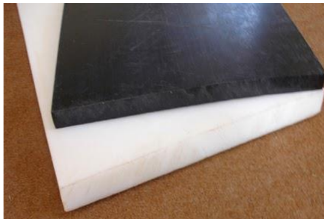
Gambar 2.3 Bahan Komposit Pom Polyacetal
