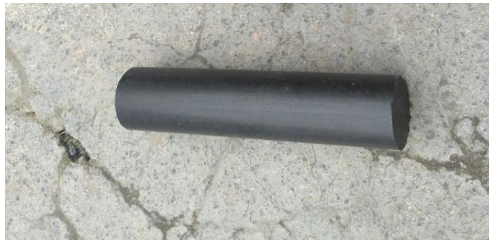
Gambar 3.3 Spesimen Poros Roda Gigi Cacing Komposit Sebelum Dibuat.
