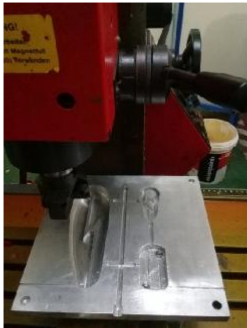
Gambar 3.19. Proses Pembuatan Alur Masuk dan Alur Keluar
