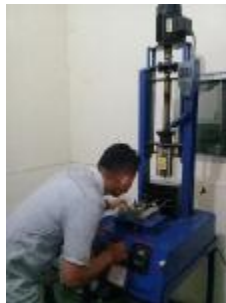
Gambar 3.21. Pengujian cetakan pada mesin cetak injeksi moulding
