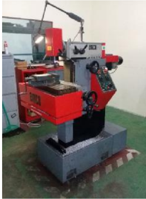
Gambar 3.6. Mesin frais (Milling)
