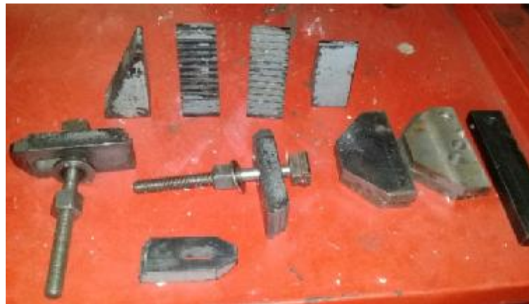
Gambar 3.12. Baut, mur dan ganjal mesin milling
