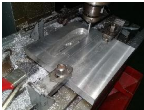
Gambar 3.18. Proses Pembentukan Aksesoris Motor Pertama (cavity)
