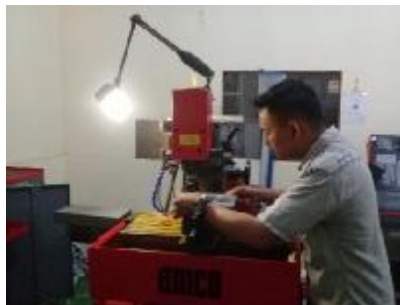
Gambar 3.16. Proses Pemasangan Meja Pembagi
