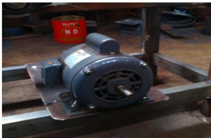
Gambar 3.3 Motor Induksi 1 Fasa
