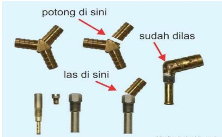
Gambar 3.12 Penyambungan pada nepel main jet
