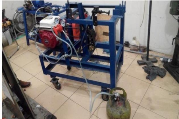
Gambar 3.1 alat uji brake dynamometer
