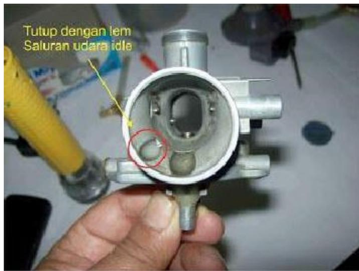
Gambar 3.11 saluran udara idle
