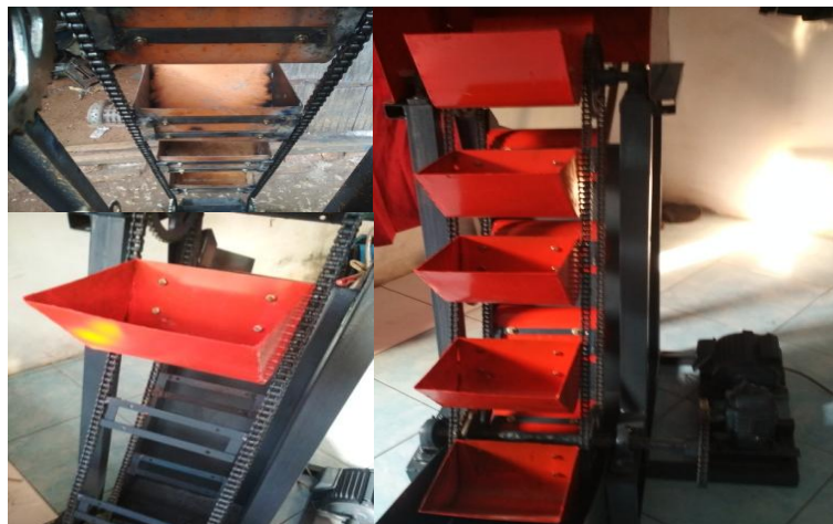
Gambar 3.16 Pemasangan Mangkuk ( Bucket ).
