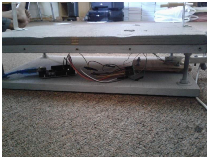
Gambar 3.41 Pemasangan Baut Dengan Lem 2 Ton
