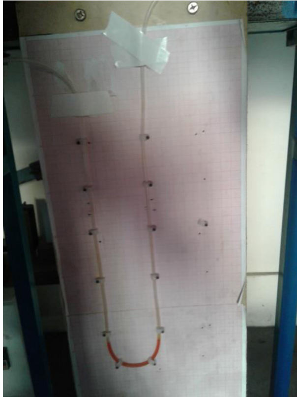
Gambar 3.37 Pemasangan Selang Infuse Pada Papan Triplek
