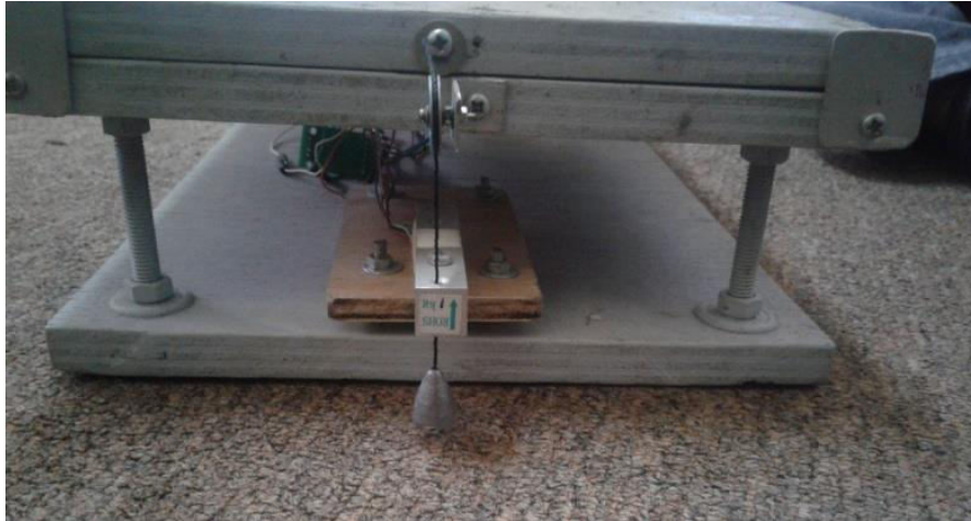
Gambar 3.44 Pemasangan Load Cell
