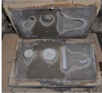
Gambar 4.9. Hasil Pengecoran sebelum dikeluarkan dari cetakan
