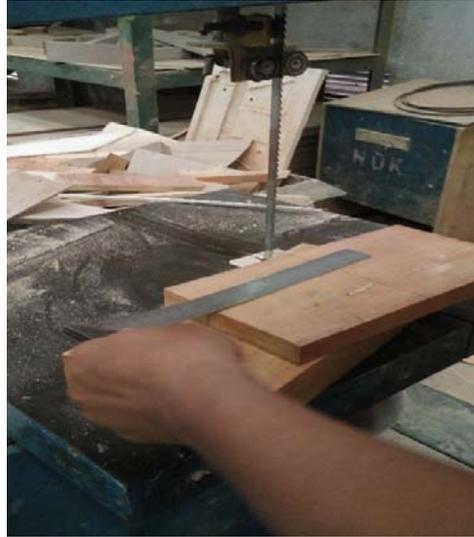
Gambar 3.15. Proses pemotongan dengan mesin gergaji (*Band saw*)
