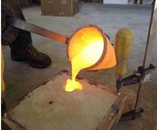
Gambar 3.20 Penuangan cairan logam
