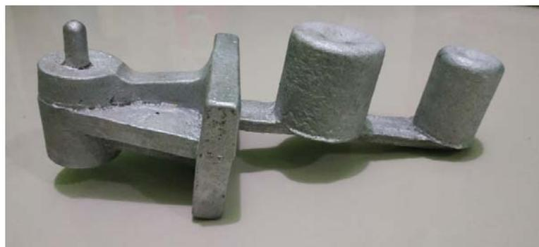
Gambar 4.10. Hasil Produk (*Braket material Aluminium*)
