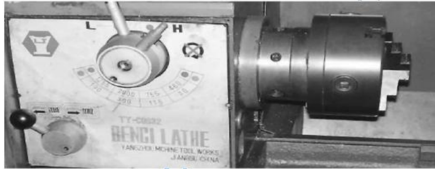
Gambar 2.6: Spindel Penggerak pada Bench Lathe(Cindyantika,2013).
