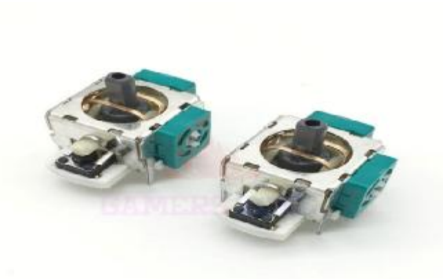
Gambar 2.10 Potensiometer (Variabel Resistor) pada Joystick PS2
