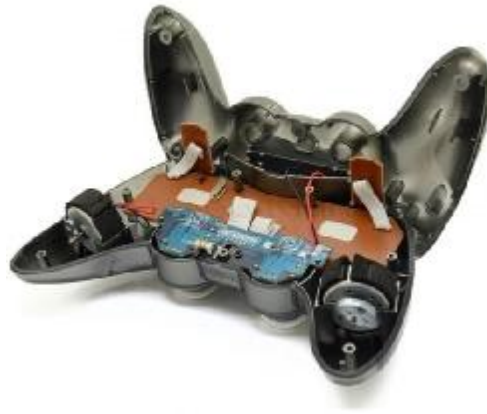
Gambar 2.11 Motor listrik yang terdapat pada Joystick PS2
