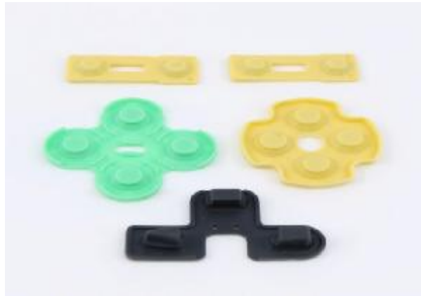
Gambar 2.9 Directional Pad pada Joystick PS2
