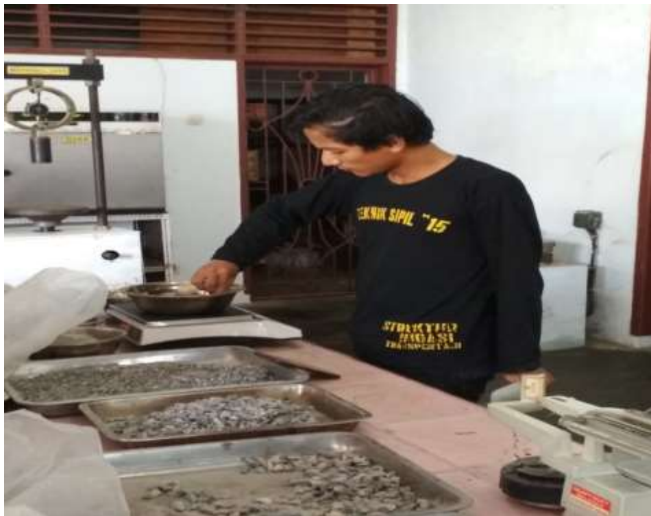
Gambar L4: Mencampur agregat halus, agregat kasar, Serat serabut kelapa sebelum dipanaskan dan dicampur dengan aspal.
