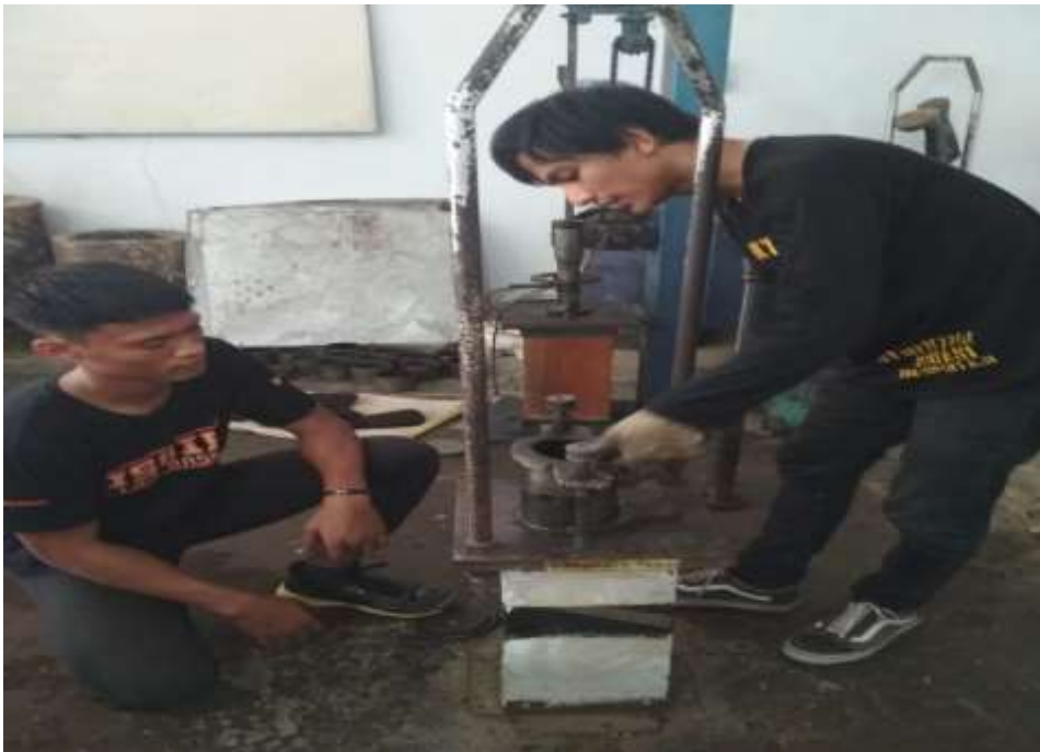
Gambar L6: Penumbukan benda uji.
