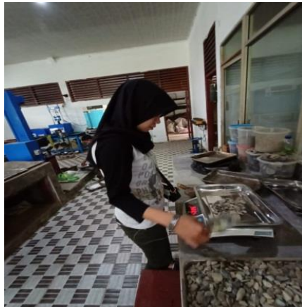
Proses Penimbangan Agregat Untuk Pembuatan Benda Uji
