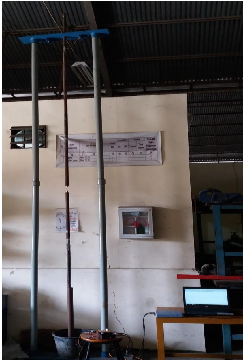
Gambar 3.7 Alat Uji Impak Batang Hopkinson Bar
