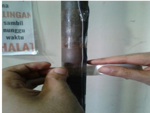
Gambar 3.15 Pemasangan Kabel Strain Gages
