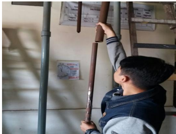
Gambar 3.20 Pemasangan Striker Bar
