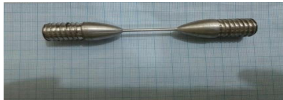
Gambar 3.5 Spesimen Uji Dinamik Bahan Aluminium
