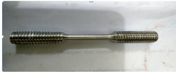
Gambar 3.3 Spesimen Uji Statis Bahan Aluminium
