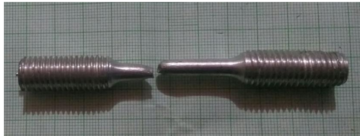
Gambar 4.1 Spesimen Uji Statis Berbahan Aluminium
