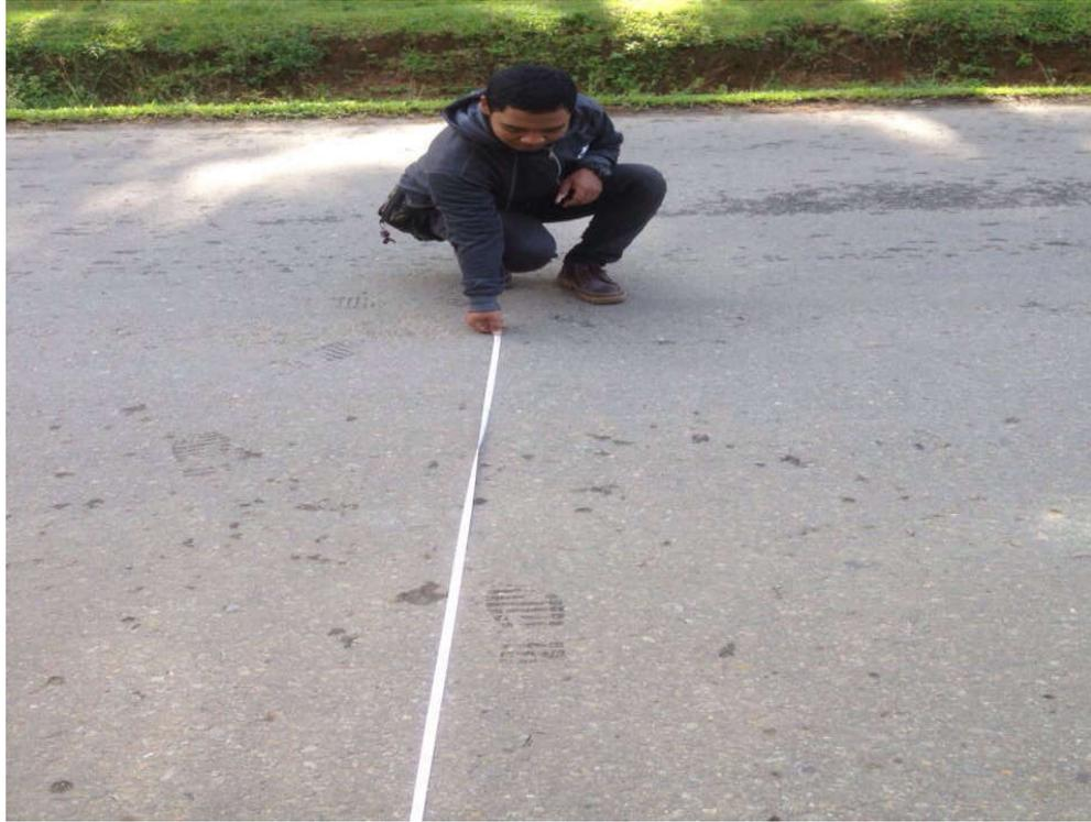
Gambar L.3: Mengukur lebar lajur di jalan Bahorok-Binjai.
