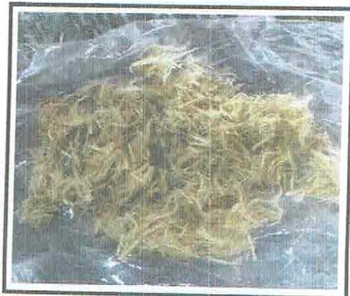
1.1: Proses pemilihan, pemisahan, pemotongan hingga penimbangan serat daun nanas sebelum dicampur ke beton.
