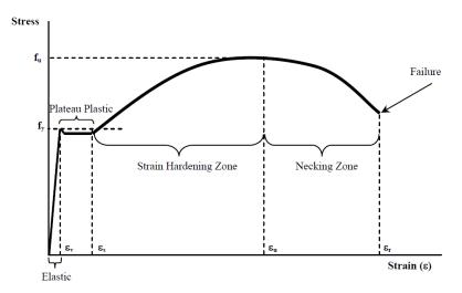
Gambar 2.5: Perilaku tegangan dan regangan material baja.
