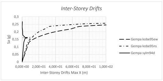
Gambar 4.3: Grafik perbandingan *Inter-Storey Drifts* pada variasi gempa.
