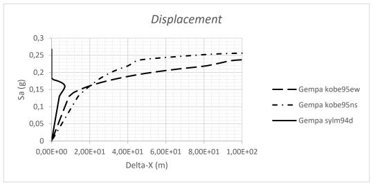
Gambar 4.1: Grafik perbandingan nilai *Displacement* pada variasi gempa.
