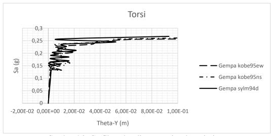
Gambar 4.2: Grafik perbandingan torsi pada variasi gempa.
