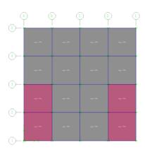
Gambar 3.5: Analogi struktur gedung tidak beraturan berbentuk T.
