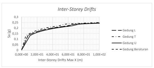
Gambar 4.6: Grafik perbandingan *Inter-Storey Drifts* pada gedung tidak beraturan horizontal.
