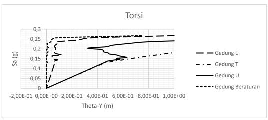
Gambar 4.5: Grafik perbandingan torsi pada gedung tidak beraturan horizontal.
