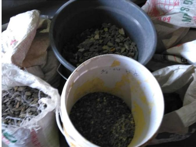
Gambar 1 : Agregat Kasar yang di gunakan Batu Pecah Binjai.
