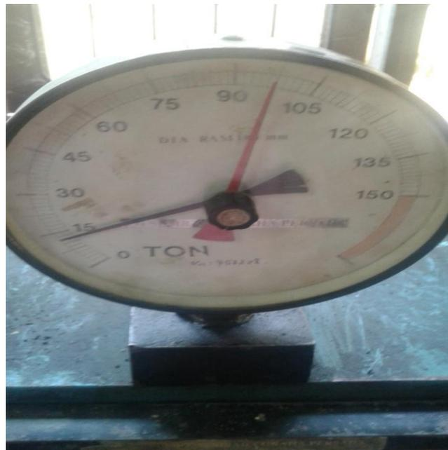
Gambar 16 : Pengujian kuat tekan beton yang menggunakan pasir Langkat 96 T pada umur 28 hari.
