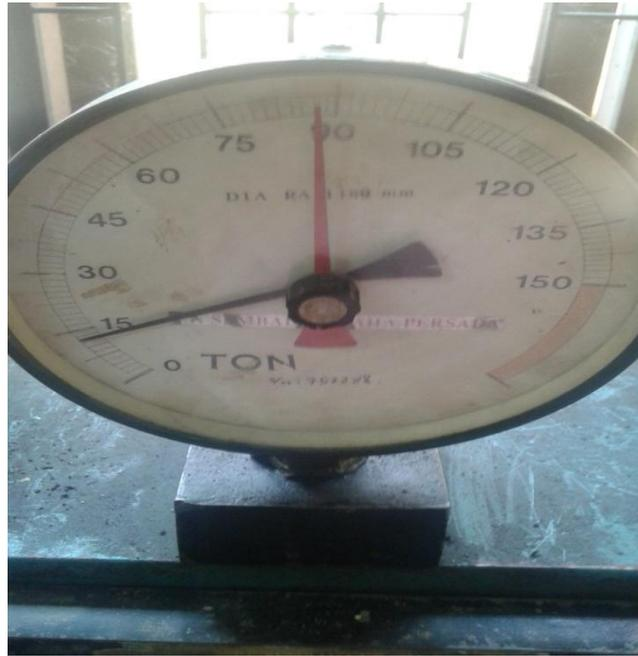
Gambar 13 : Pengujian kuat tekan beton yang menggunakan pasir Binjai 85.5 T pada umur 28 hari.
