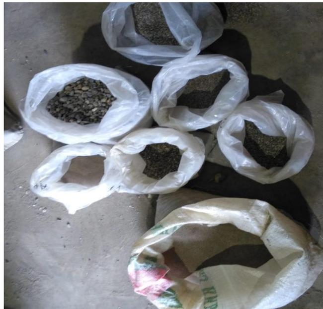
Gambar 4: Agregat Halus yang di gunakan Pasir Langkat.
