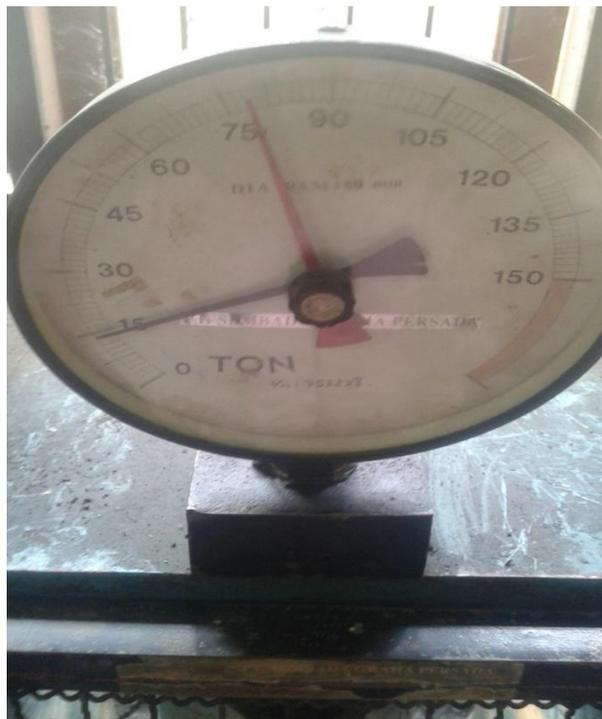
Gambar 10: Pengujian kuat tekan beton yang menggunakan pasir Langkat 78 T pada umur 28 hari
