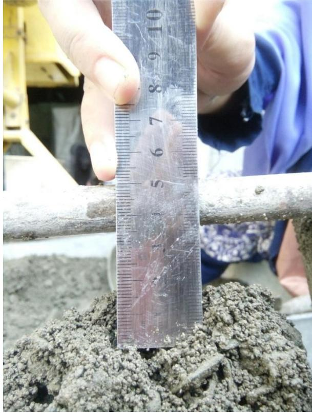
Gambar 7 : Slump Test
