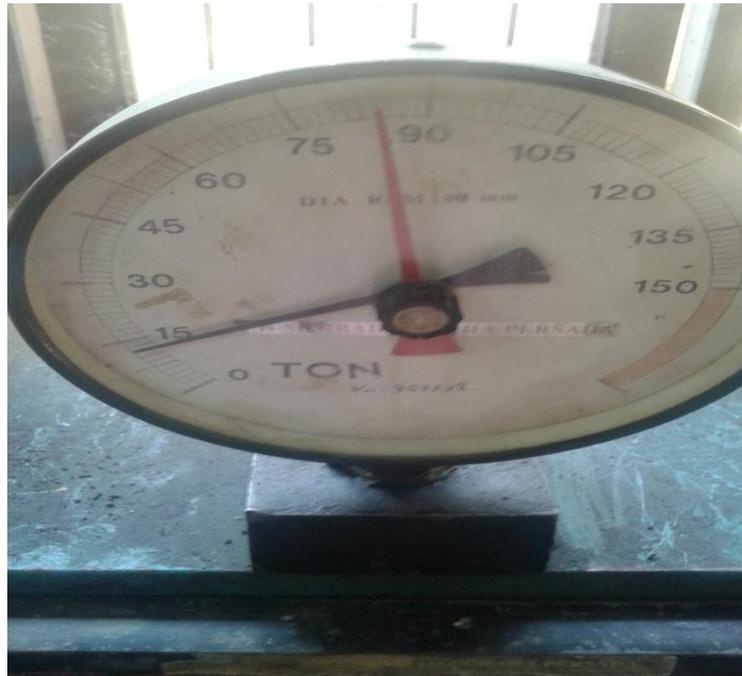
Gambar 11 : Pengujian kuat tekan beton yang menggunakan pasir Binjai 84 T pada umur 28 hari.
