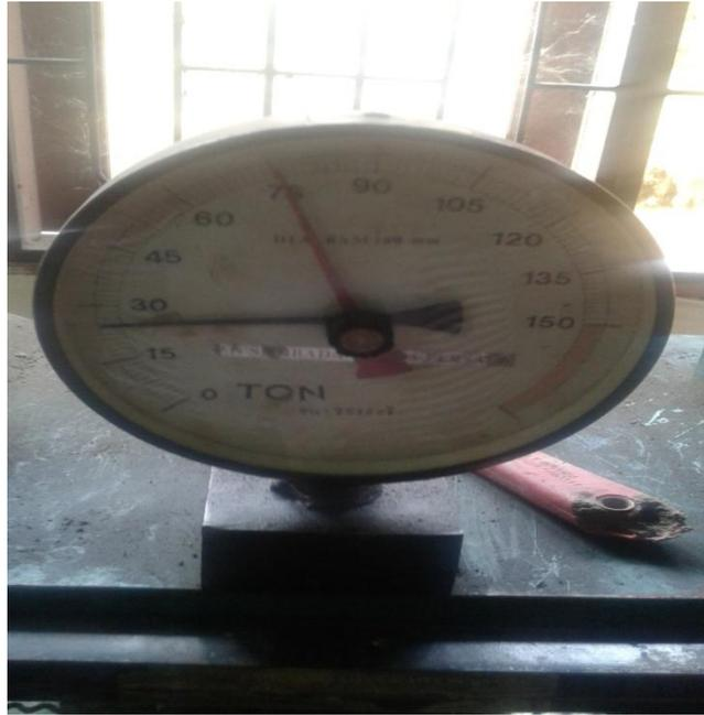
Gambar 9: Pengujian kuat tekan beton yang menggunakan pasir Binjai 75 T pada umur 28 hari
