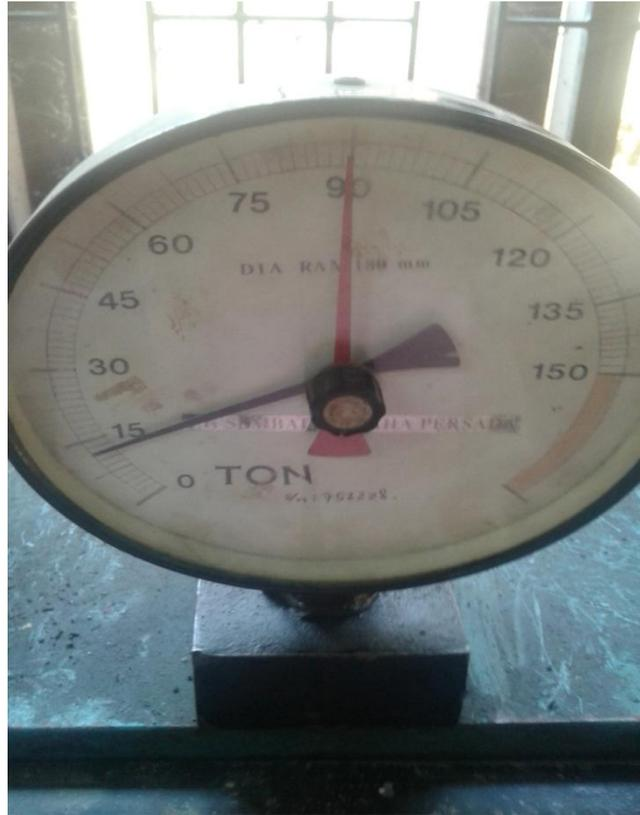
Gambar 15 : Pengujian kuat tekan beton yang menggunakan pasir Binjai 90 T pada umur 28 hari.
