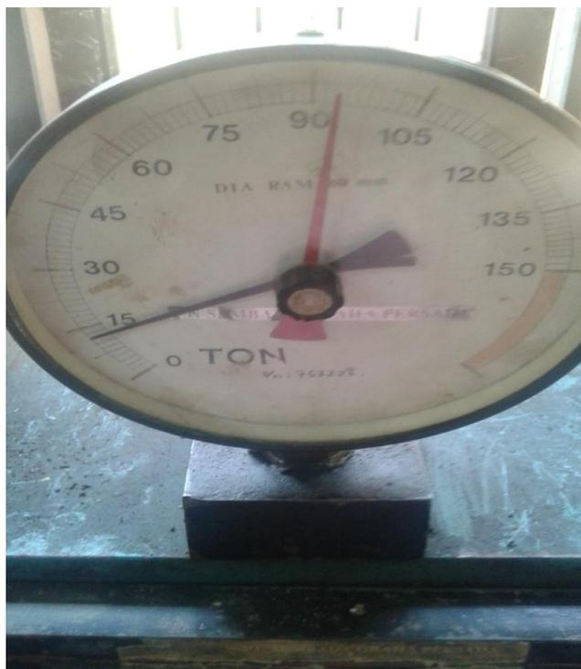
Gambar 14 : Pengujian kuat tekan beton yang menggunakan pasir Langkat 93 T pada umur 28 hari.
