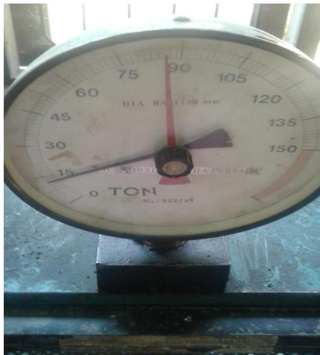
Gambar 12 : Pengujian kuat tekan beton yang menggunakan pasir Langkat 87 T pada umur 28 hari.
