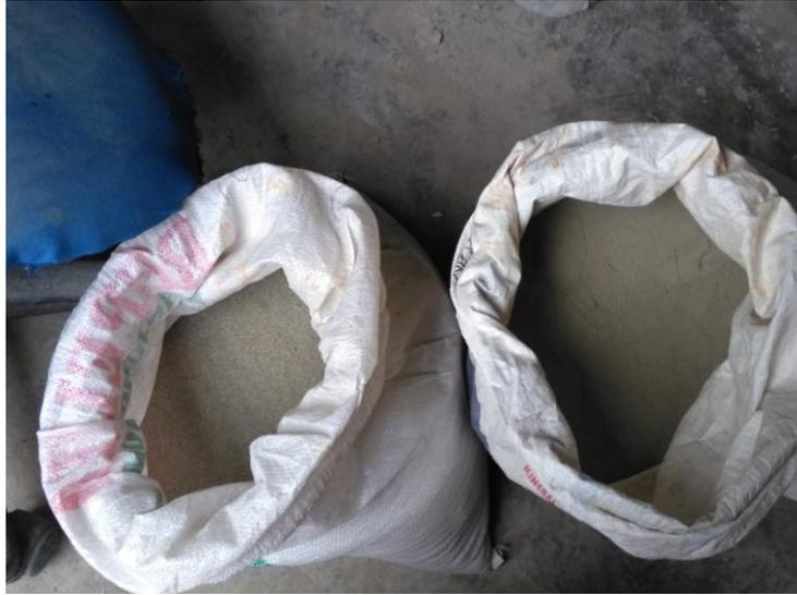
Gambar 3 : Agregat Halus yang di gunakan Pasir Binjai.
