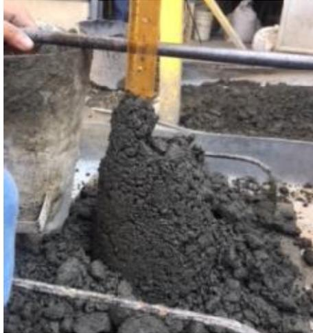
Gambar L.5. Pengujian *slump*
