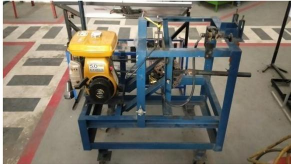
Gambar 3.5. Brake Dynamometer
