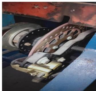
Gambar 3.29. Letak Caliper Rem
