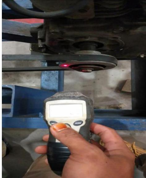
Gambar 3.30. Mengukur Rotasi Mesin Menggunakan Tachometer
