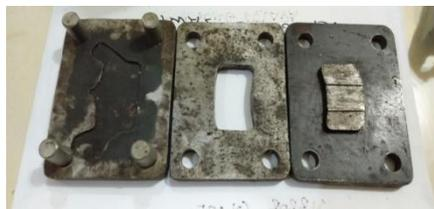
Gambar 3.2. Cetakan atau Mal
