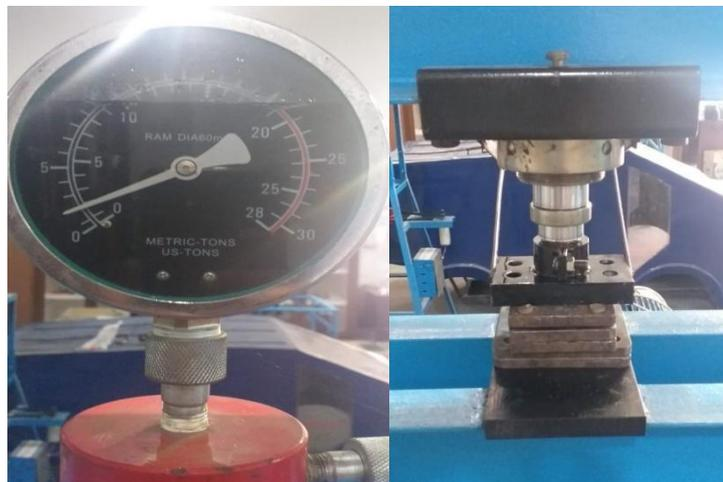
Gambar 3.25. Proses Kompaksi Atau Penekanan
