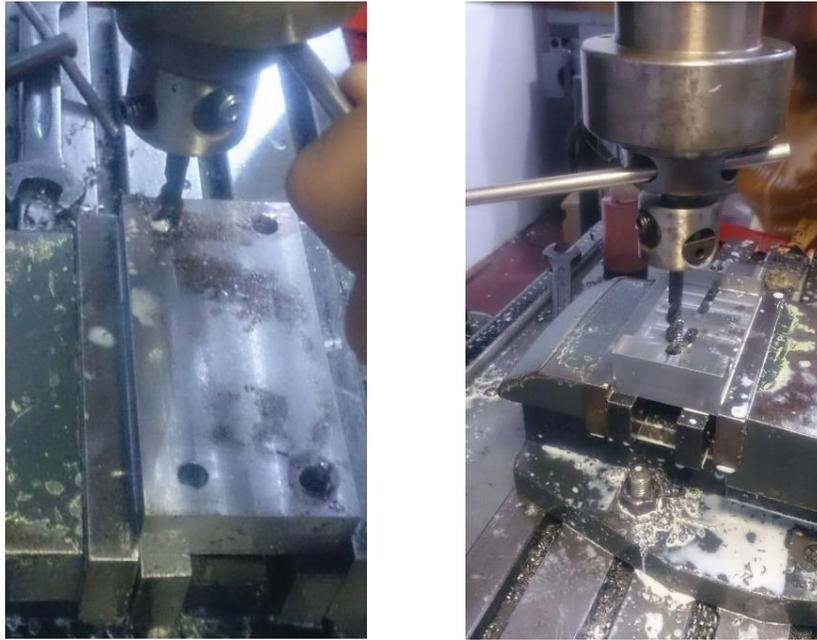
Gambar 4.11 melakukan pengetapan
