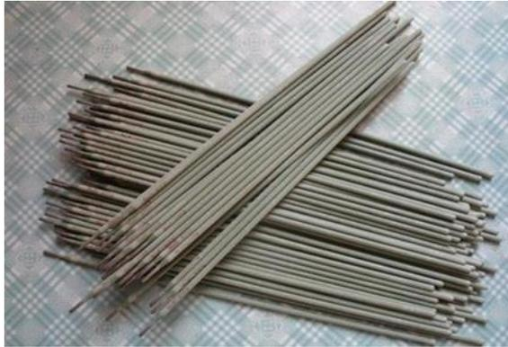
Gambar 3.16 Elektroda
