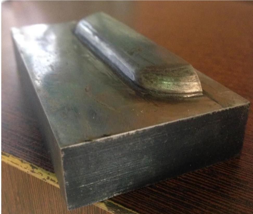
Gambar 4.13 Hasil pembuatan *punch* bentuk *louver*
