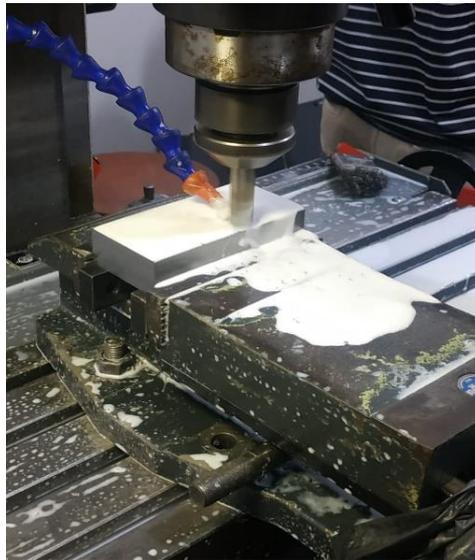
Gambar 4.9 Membuat *punch slotting*
