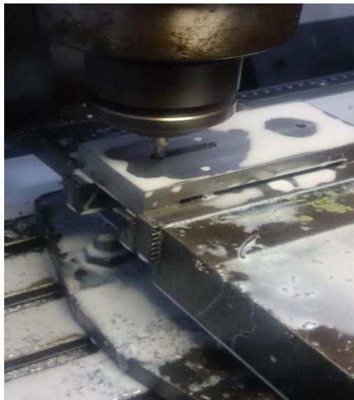
Gambar 4.10 Membuat *die slotting*
